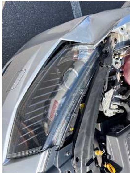
Stoßstange vorne (Riss/Bruch)
