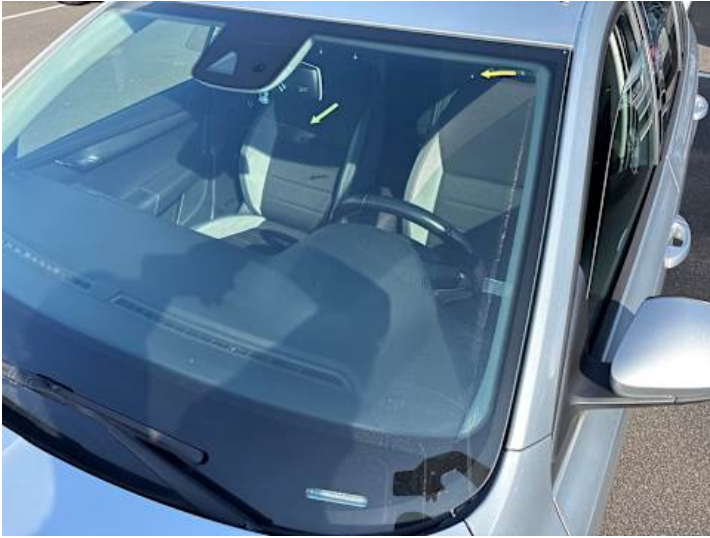
Windschutzscheibe (Kratzer, Steinschlag)
