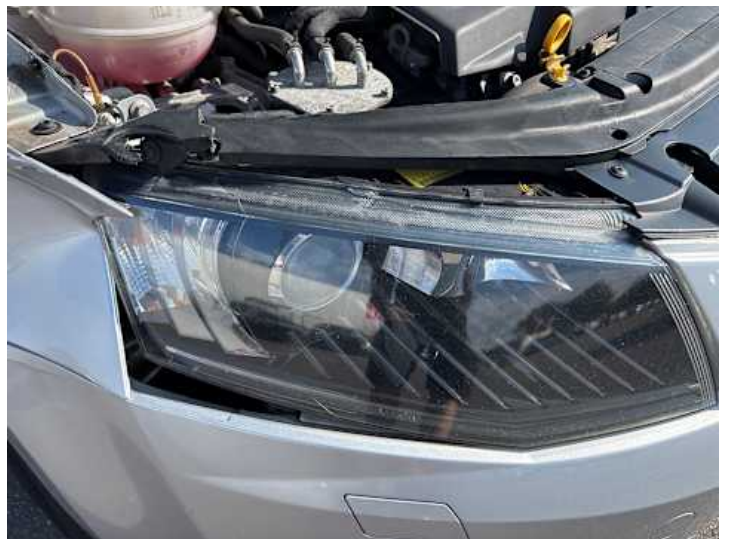
Scheinwerfer (rechts) (Riss/Bruch)
