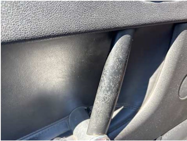
Innenraum (Verschmutzung, Verschleiß)
