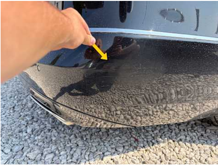
Stoßstange hinten (Kratzer, Lackschaden, Unsachgemäß instand gesetzt, Verformung)
