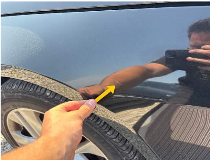
Kotflügel vorne links (Kratzer, Lackschaden)
