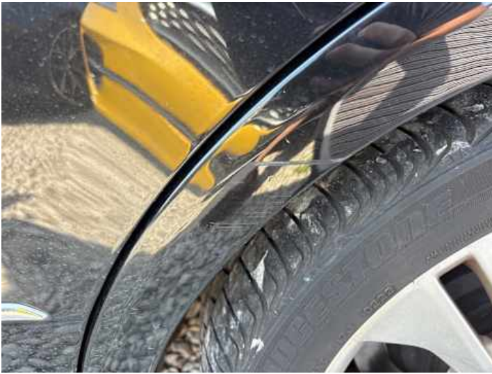
Seitenteil hinten links (Delle, Kratzer, Lackschaden, Unsachgemäß instand gesetzt)
