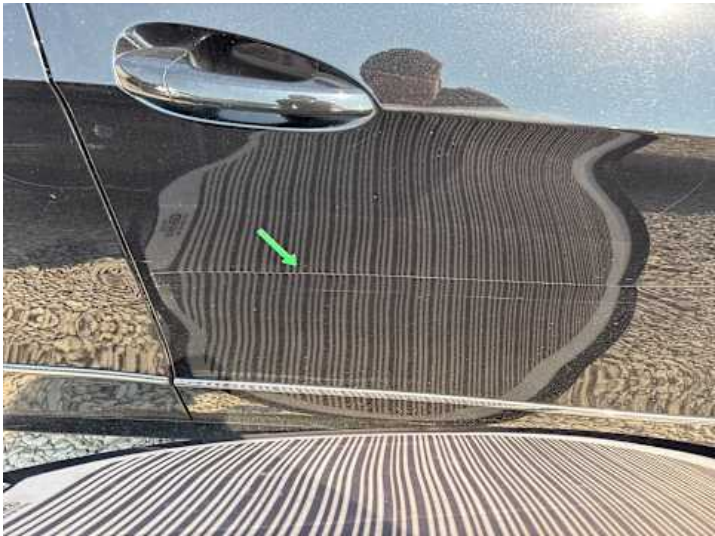
Beifahrtür (Kratzer, Lackschaden, Verformung, Delle)
