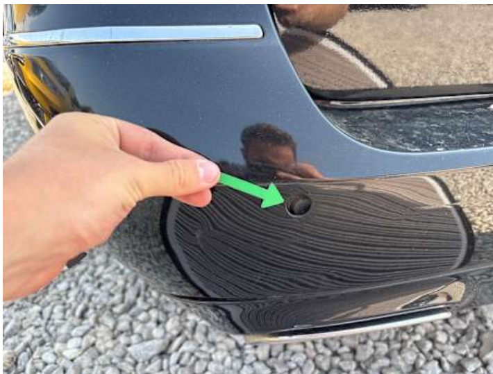
Stoßstange hinten (Anderer Schaden): Parksensor eingedrückt
