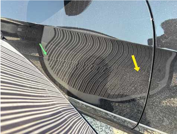
Beifahrtür (Kratzer, Lackschaden, Verformung, Delle)
