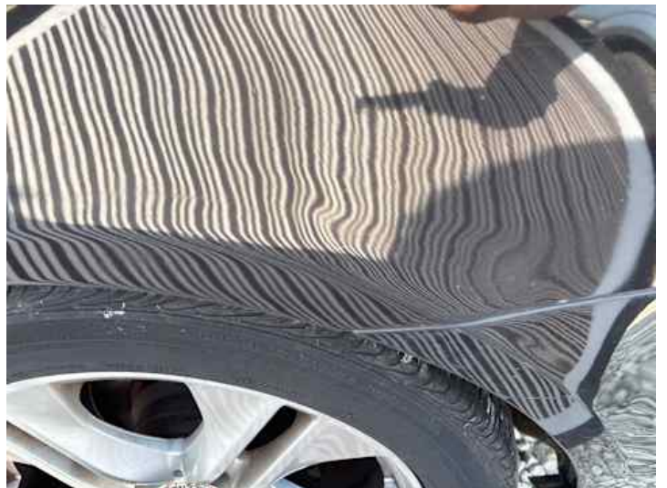
Seitenteil hinten links (Delle, Kratzer, Lackschaden, Unsachgemäß instand gesetzt)
