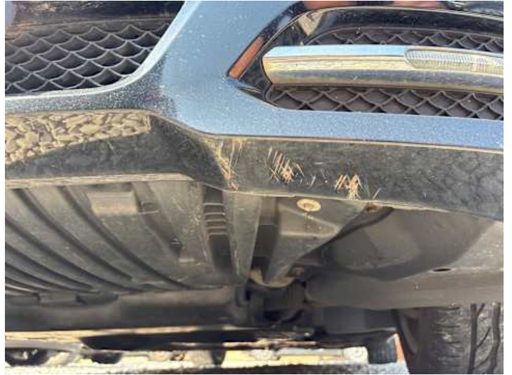
Stoßstange vorne (Kratzer, Lackschaden)
