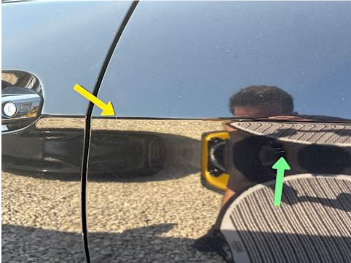
Türe hinten links (Kratzer, Lackschaden, Delle)
