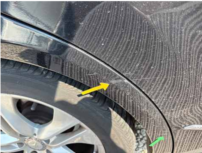
Seitenteil hinten rechts (Verformung, Lackschaden, Rost, Kratzer)
