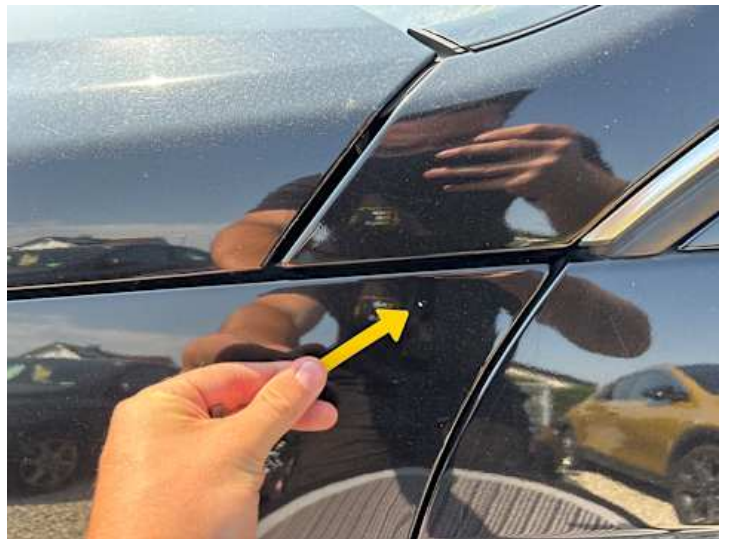
Kotflügel vorne links (Kratzer, Lackschaden)
