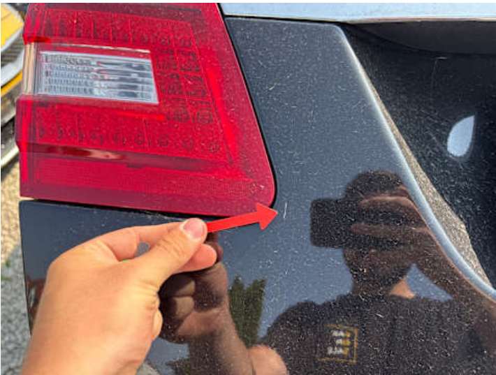
Heckklappe (Kratzer, Lackschaden)
