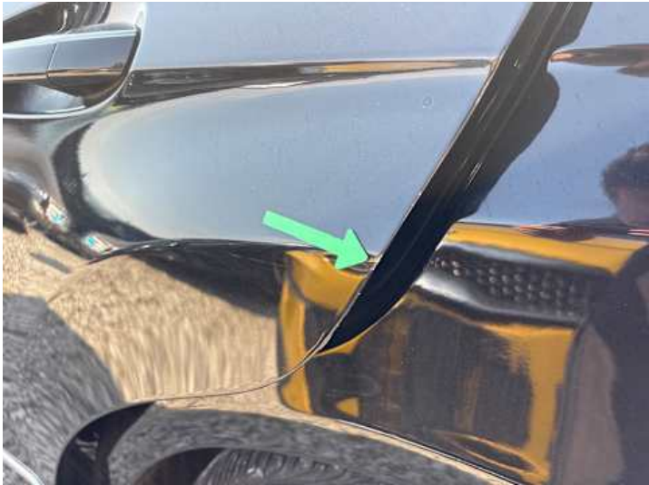
Türe hinten links (Kratzer, Lackschaden, Delle)
