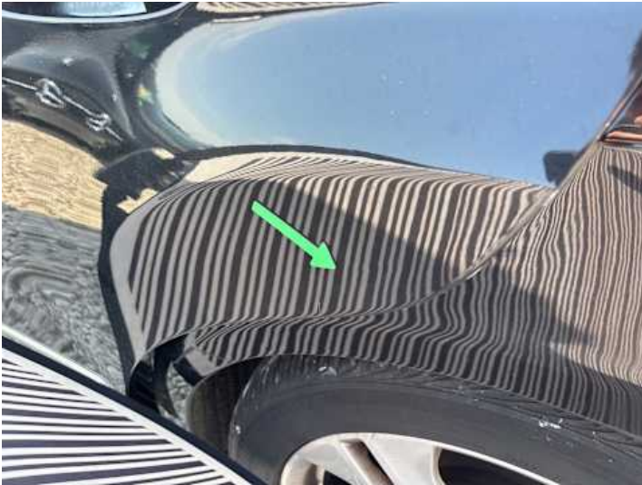
Türe hinten links (Kratzer, Lackschaden, Delle)
