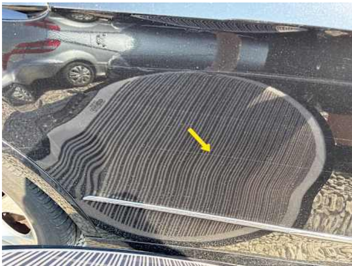
Türe hinten rechts (Verformung, Kratzer, Lackschaden)
