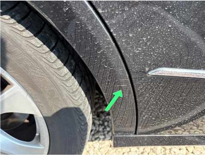
Seitenteil hinten rechts (Verformung, Lackschaden, Rost, Kratzer)
