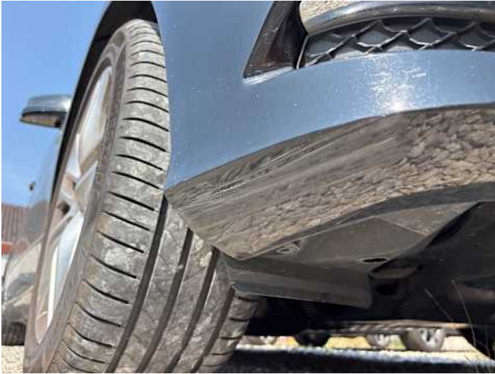
Stoßstange vorne (Kratzer, Lackschaden)
