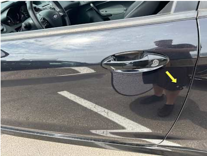
Fahrtür (Delle, Kratzer)
