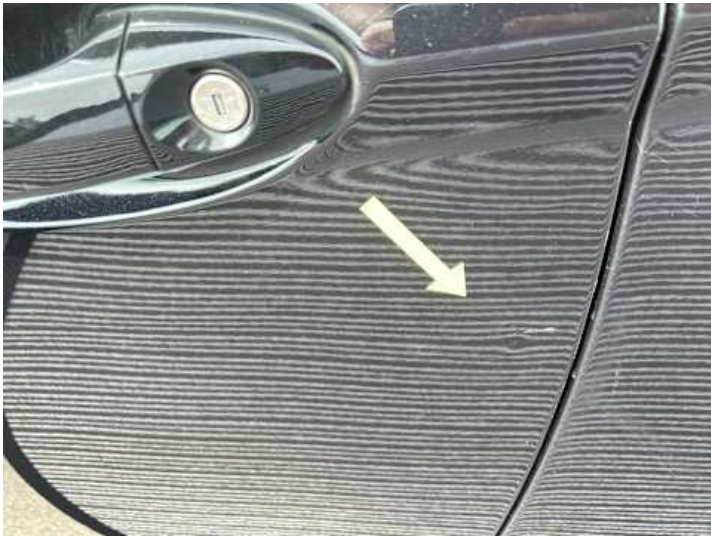
Fahrtür (Delle, Kratzer)
