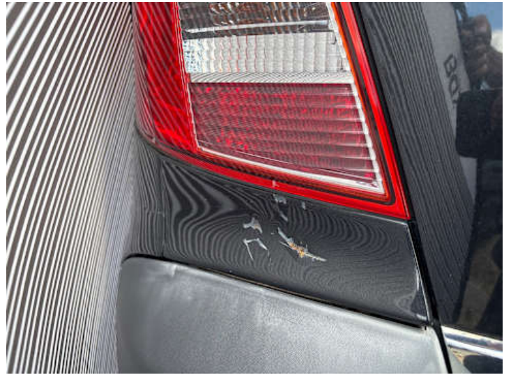
Seitenteil hinten links (Verformung, Lackschaden)
