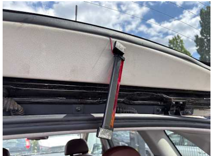
Heckklappe (Riss/Bruch, Unsachgemäß instand gesetzt)
