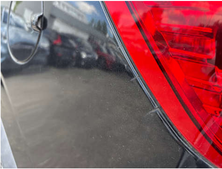
Seitenteil hinten links (Riss/Bruch)
