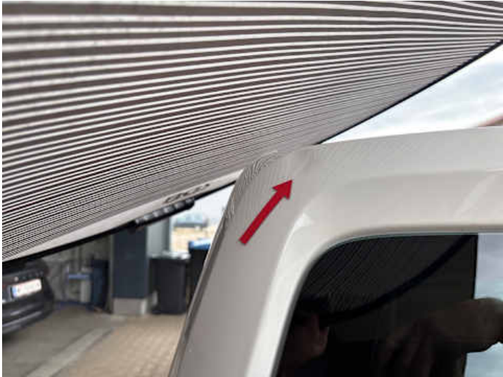
Heckklappe (Delle, Kratzer)
