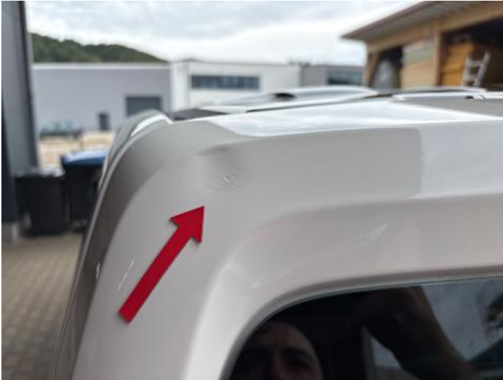
Heckklappe (Delle, Kratzer)
