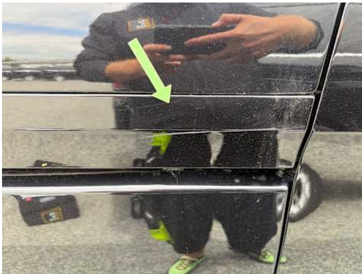
Seitenteil hinten rechts (Kratzer)
