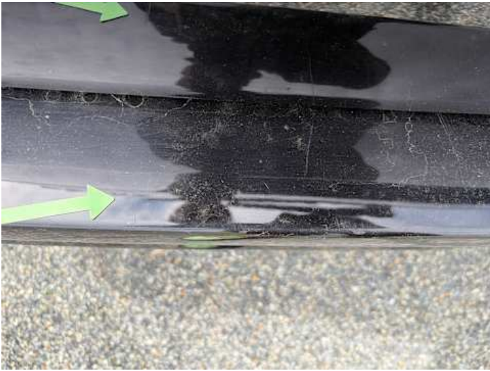
Stoßstange hinten (Kratzer)
