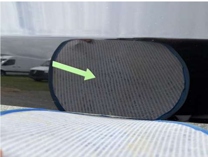
Heckklappe (Delle, Kratzer)
