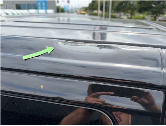
Dach (Verformung, Kratzer)
