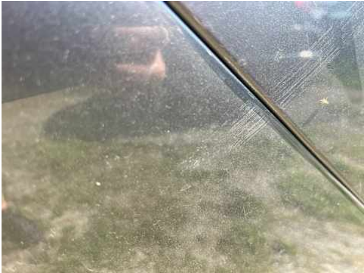
Stoßstange hinten (Kratzer)
