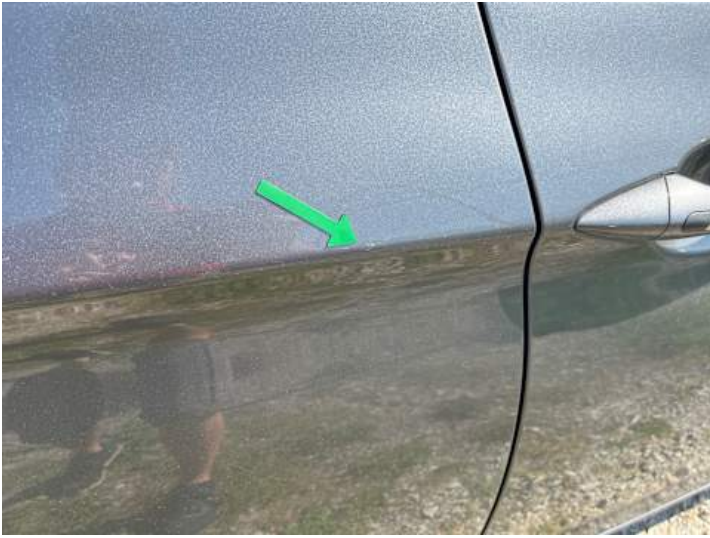
Türe hinten rechts (Lackschaden)
