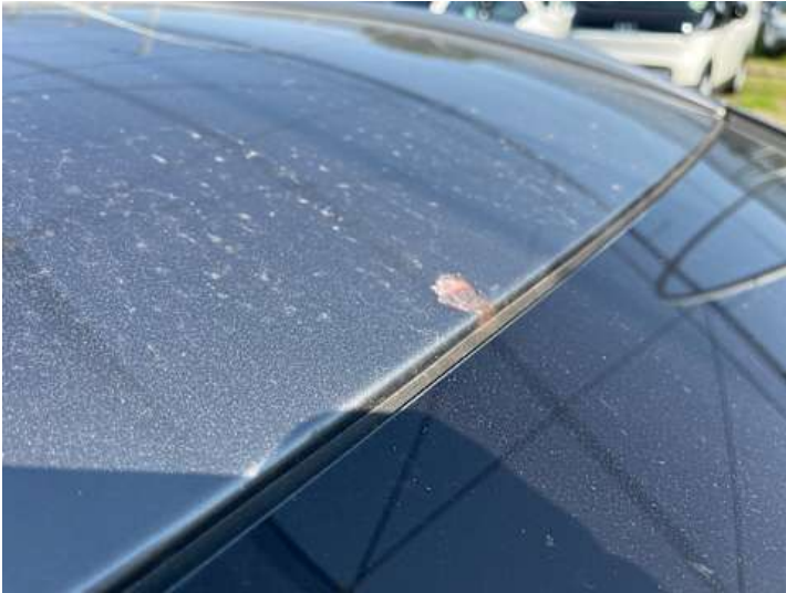
Dach (Lackschaden, Rost)
