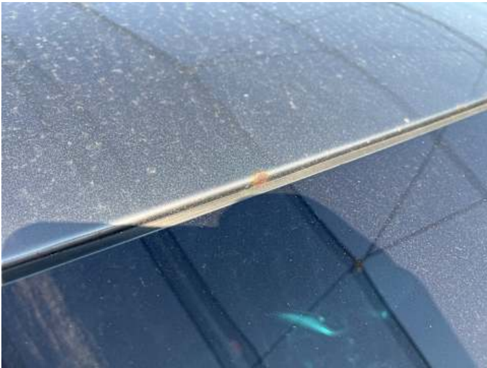
Dach (Lackschaden, Rost)
