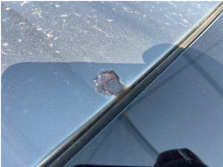
Dach (Lackschaden, Rost)
