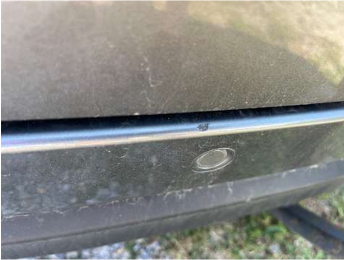
Stoßstange hinten (Lackschaden)
