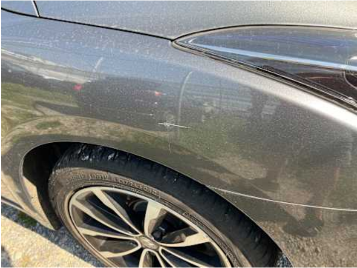
Kotflügel vorne rechts (Kratzer)
