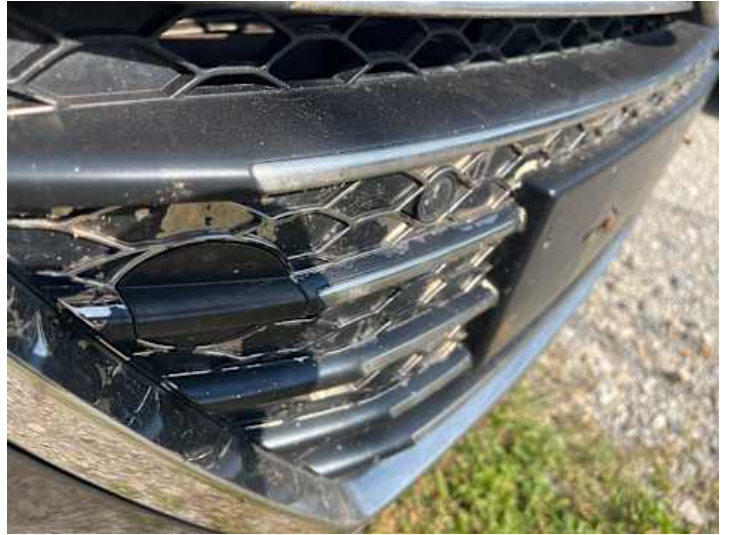
Stoßstange vorne (Lackschaden)
