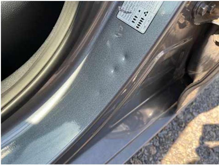
Schweller links (Delle, Kratzer)
