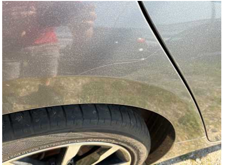
Seitenteil hinten rechts (Kratzer)
