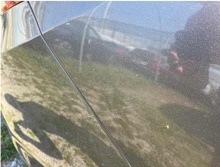
Seitenteil hinten rechts (Kratzer)
