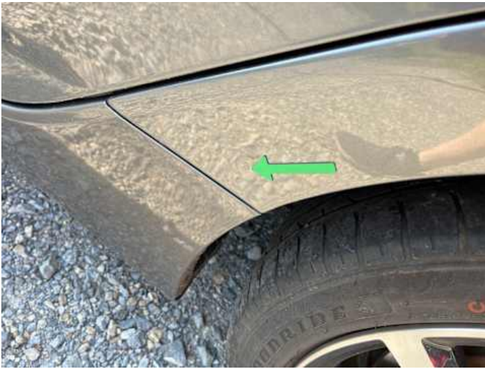
Seitenteil hinten links (Delle)
