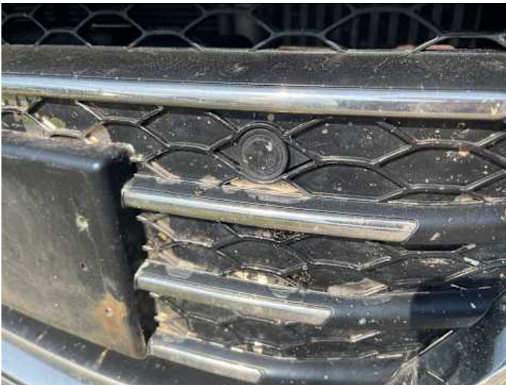
Stoßstange vorne (Lackschaden)
