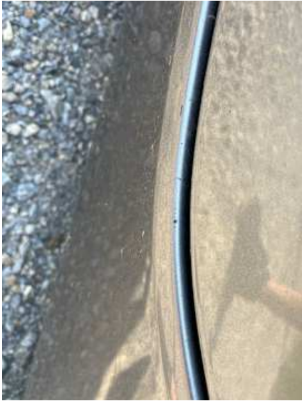
Schweller links (Lackschaden, Kratzer)
