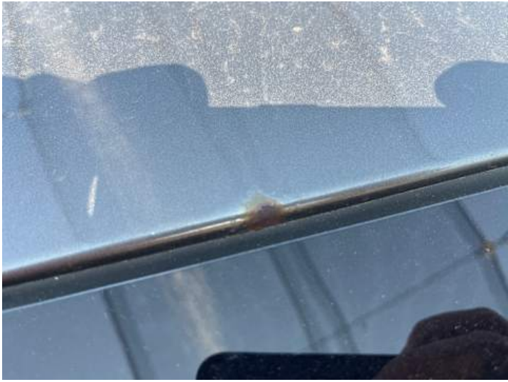
Dach (Lackschaden, Rost)
