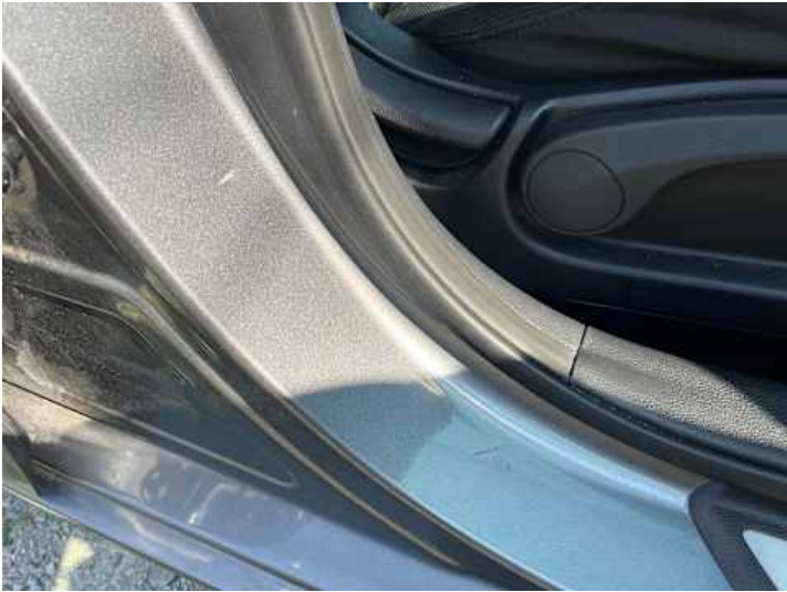
Schweller rechts (Kratzer, Delle, Lackschaden)
