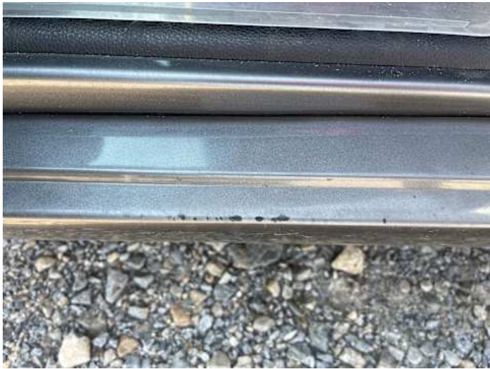
Schweller links (Lackschaden, Kratzer)
