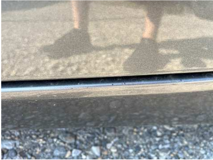
Schweller links (Lackschaden, Kratzer)
