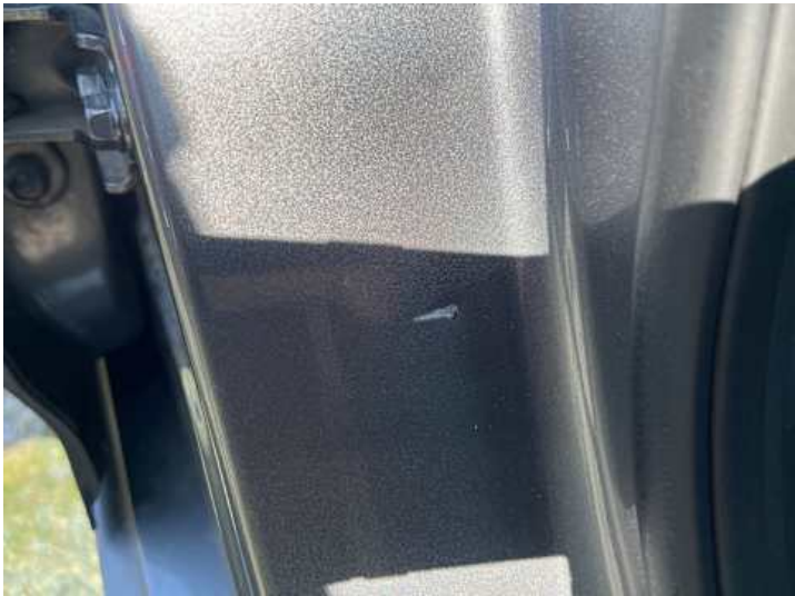
Schweller rechts (Kratzer, Delle, Lackschaden)
