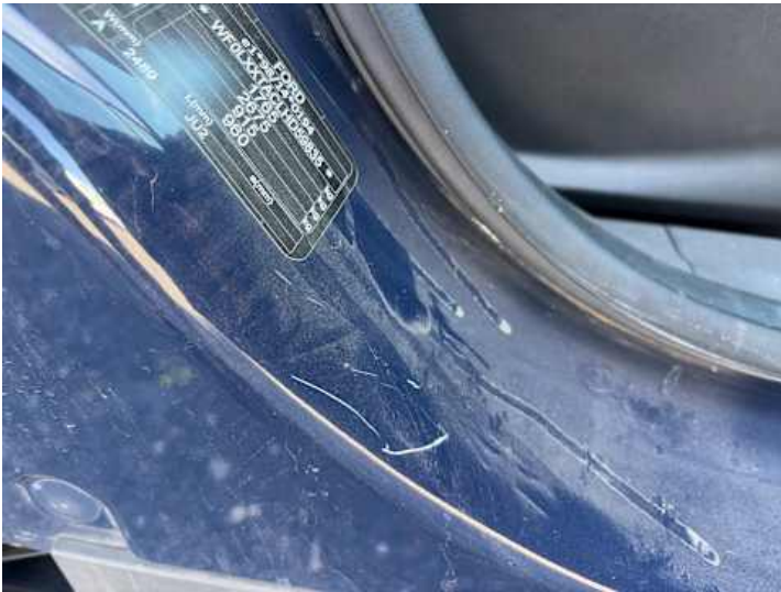
Schweller rechts (Kratzer)
