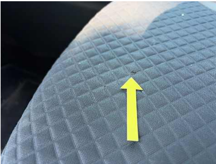
Innenraum (Riss/Bruch, Verschleiß)
