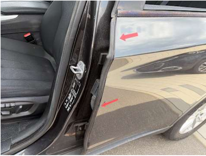
Türe hinten links (Riss/Bruch)
