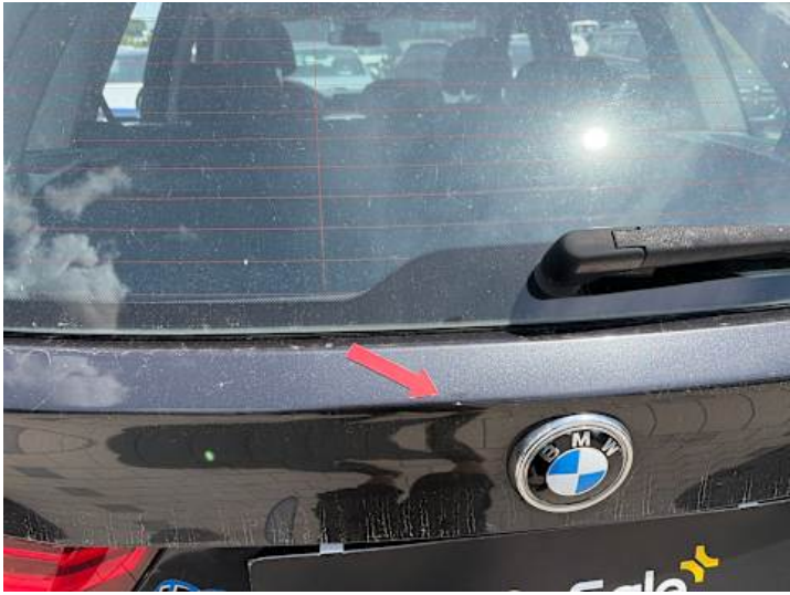
Heckklappe (Kratzer, Delle)
