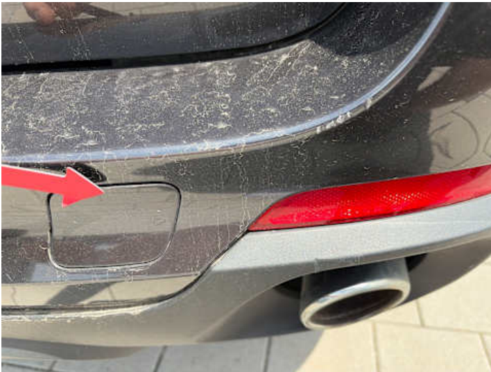
Stoßstange hinten (Kratzer, Verformung)
