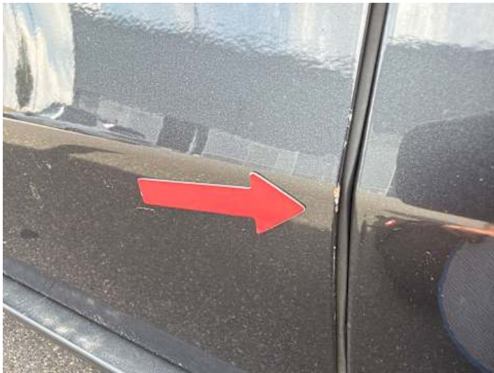
Fahrtür (Kratzer, Delle)
