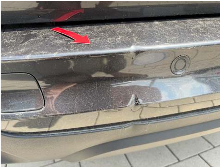
Stoßstange hinten (Kratzer, Verformung)
