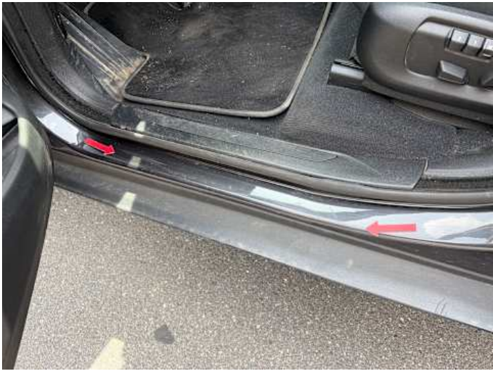
Fahrtür (Kratzer, Delle)
