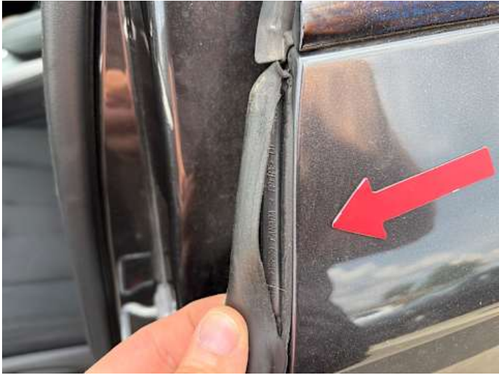
Türe hinten links (Riss/Bruch)
