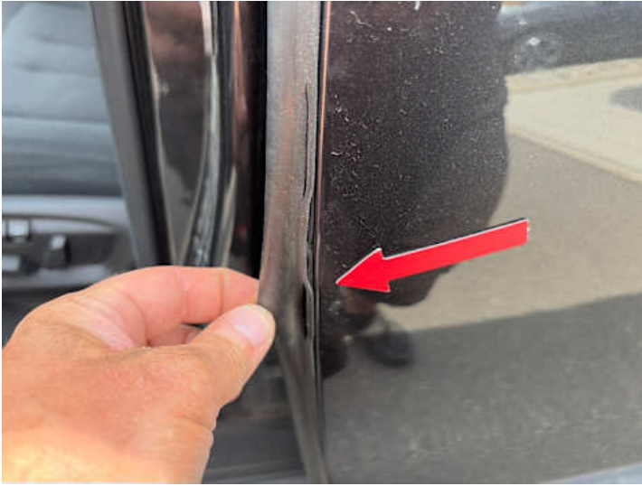
Türe hinten links (Riss/Bruch)
