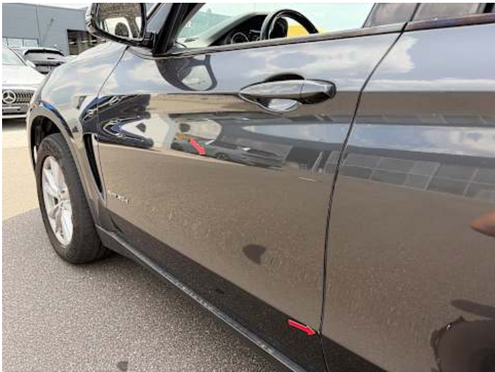
Fahrtür (Kratzer, Delle)
