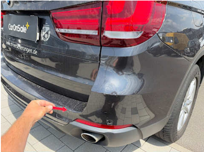
Stoßstange hinten (Kratzer, Verformung)
