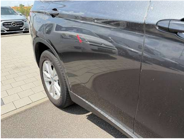
Türe hinten rechts (Kratzer, Delle)
