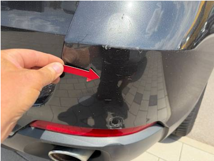
Stoßstange hinten (Kratzer, Verformung)
