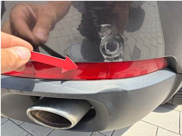
Stoßstange hinten (Kratzer, Verformung)
