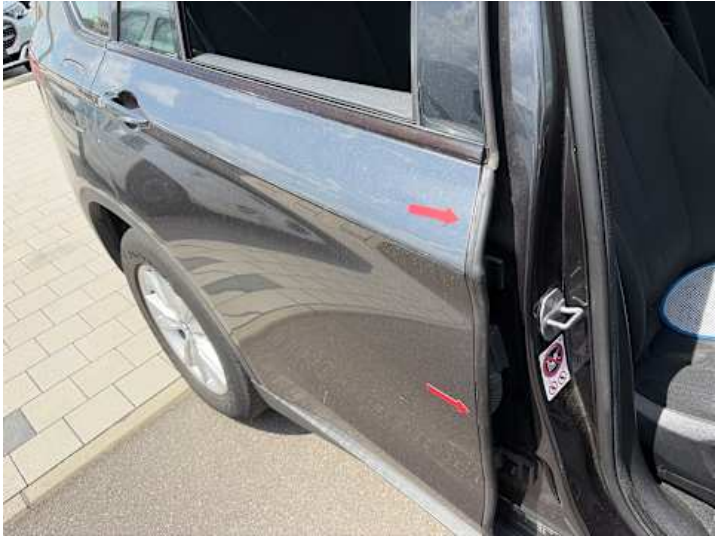
Türe hinten rechts (Riss/Bruch)
