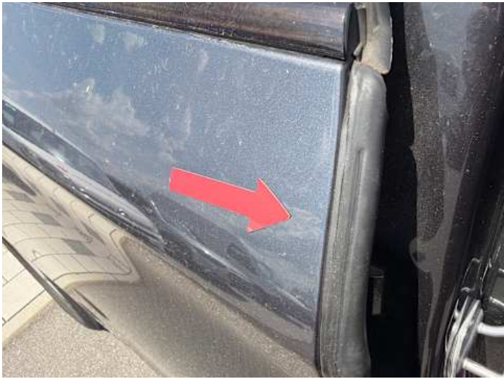
Türe hinten rechts (Riss/Bruch)
