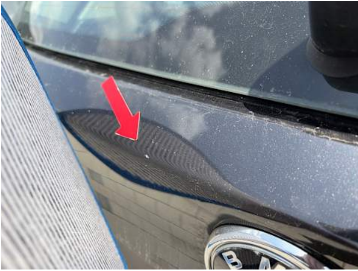
Heckklappe (Kratzer, Delle)
