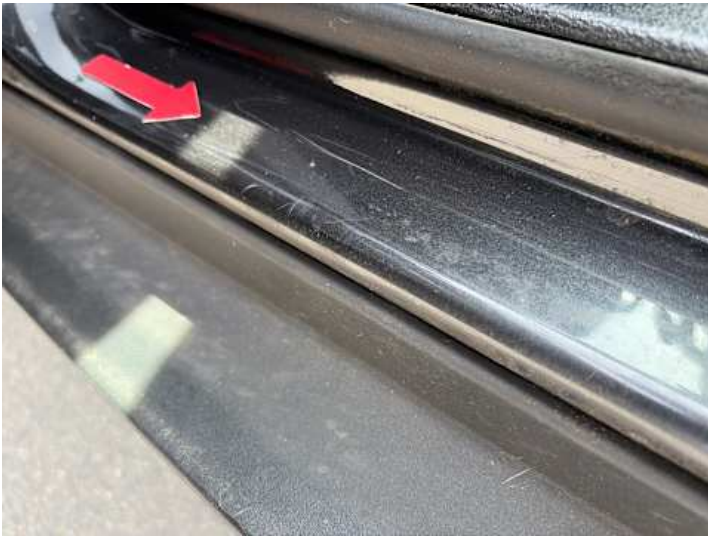
Fahrtür (Kratzer, Delle)
