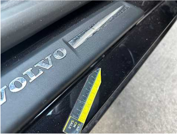
Schweller rechts (Anderer Schaden): Kerbe
