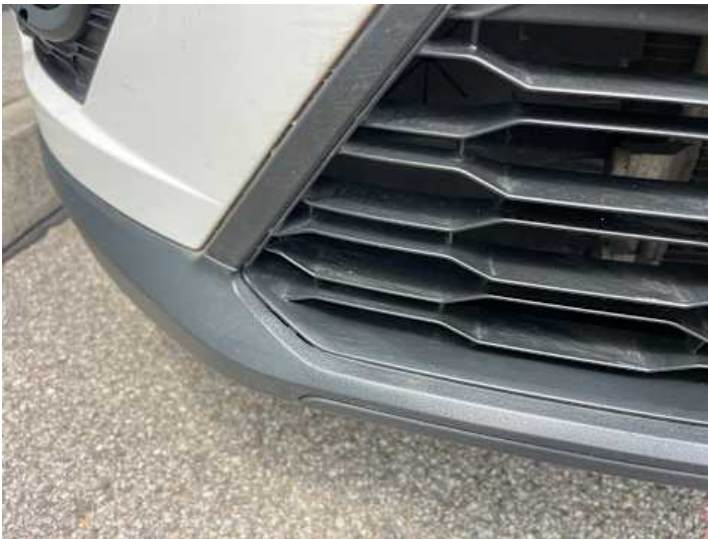
Stoßstange vorne (Spaltmaße ungenau, Riss/Bruch)
