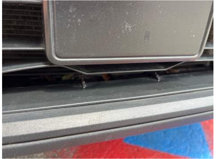
Stoßstange vorne (Spaltmaße ungenau, Riss/Bruch)
