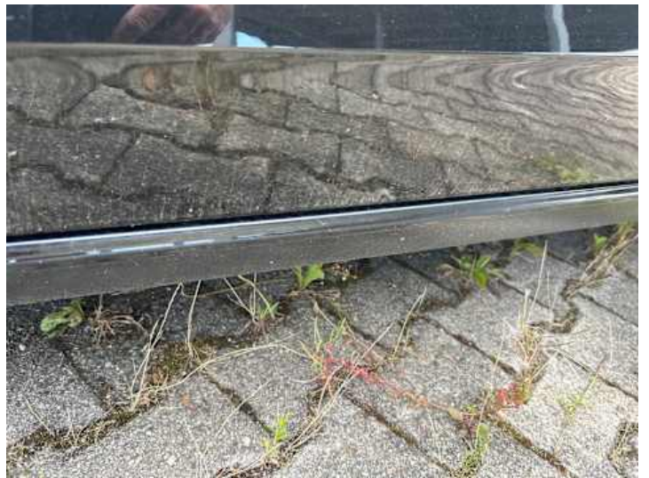
Schweller links (Kratzer)
