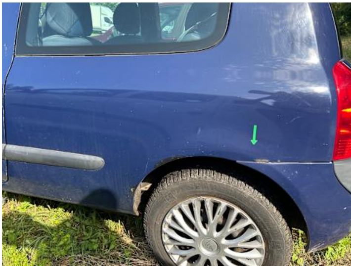
Seitenteil hinten links (Rost, Lackschaden)
