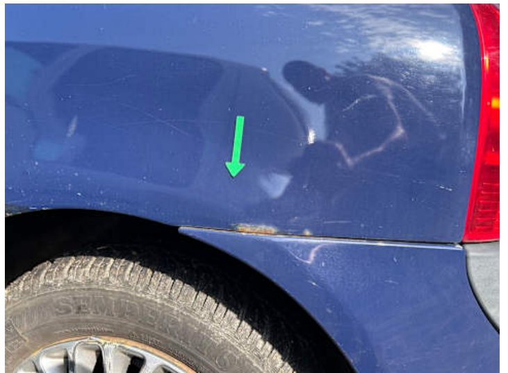
Seitenteil hinten links (Rost, Lackschaden)
