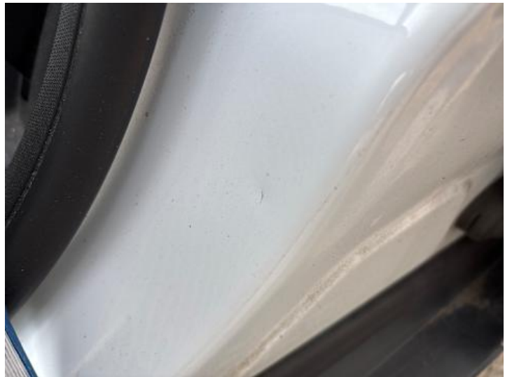
Schweller links (Delle, Kratzer)
