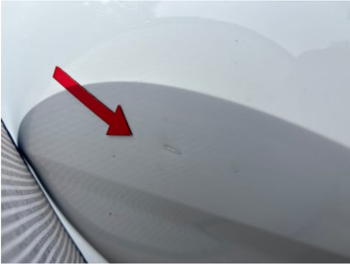
Beifahrertür (Lackschaden, Delle)
