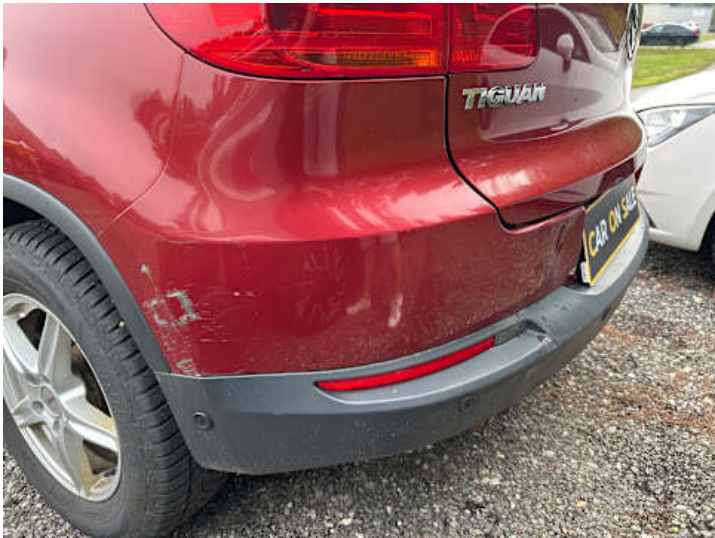
Stoßstange hinten (Lackschaden, Verformung)
