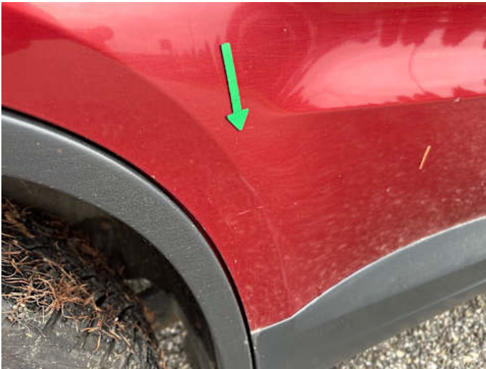
Türe hinten rechts (Lackschaden)
