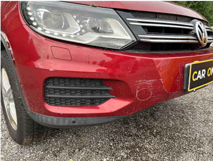
Stoßstange vorne (Lackschaden)
