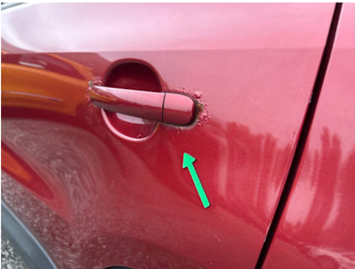
Türe hinten links (Rost)
