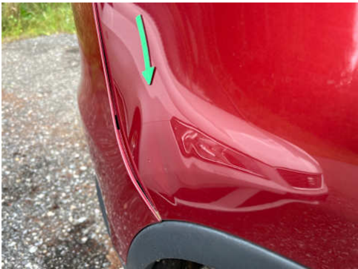
Seitenteil hinten rechts (Verformung)
