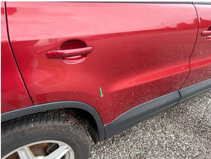
Türe hinten rechts (Lackschaden)
