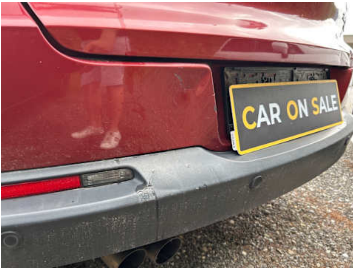
Stoßstange hinten (Lackschaden, Verformung)
