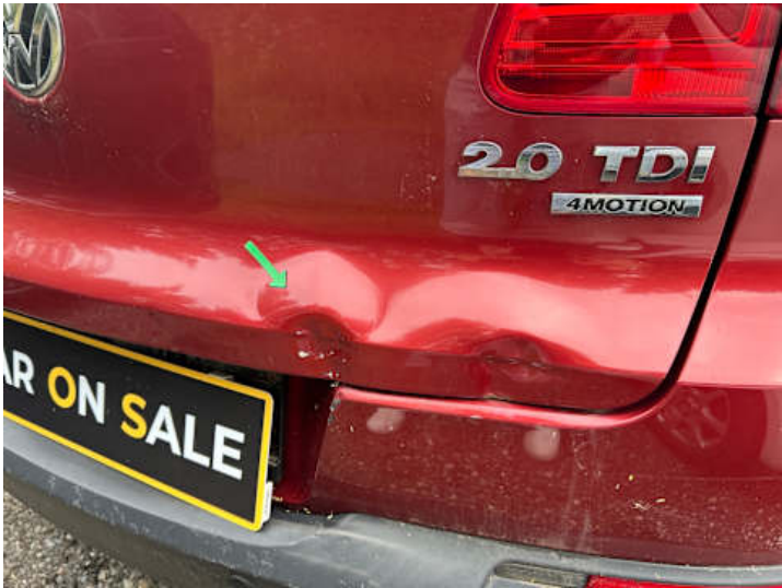
Heckklappe (Verformung, Lackschaden)
