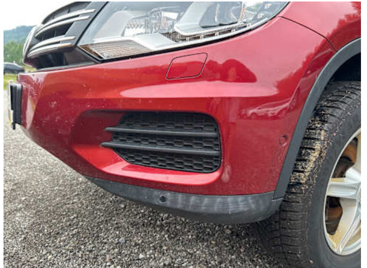
Stoßstange vorne (Lackschaden)
