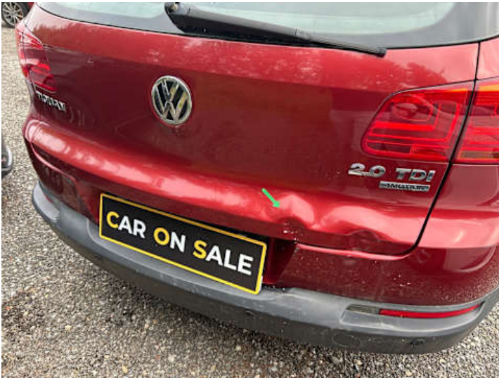
Heckklappe (Verformung, Lackschaden)
