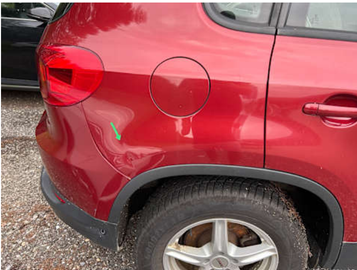
Seitenteil hinten rechts (Verformung)
