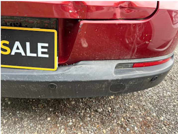
Stoßstange hinten (Lackschaden, Verformung)
