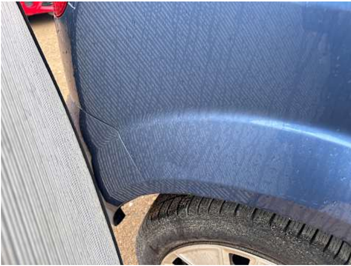
Seitenteil hinten rechts (Verformung)
