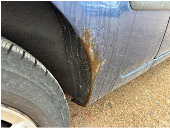
Seitenteil hinten rechts (Rost)
