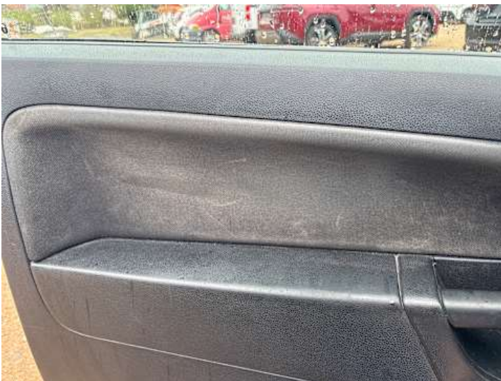
Innenraum (Verschmutzung, Verschleiß)
