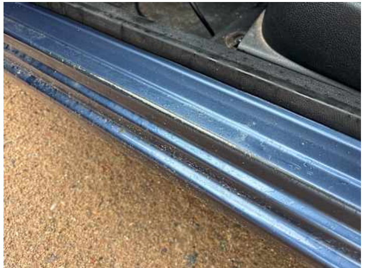
Schweller links (Kratzer)
