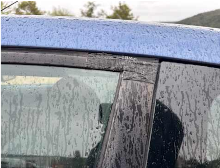
Fahrertür (Unsachgemäß instand gesetzt)
