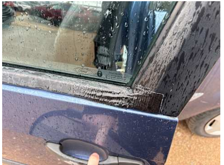
Fahrertür (Unsachgemäß instand gesetzt)
