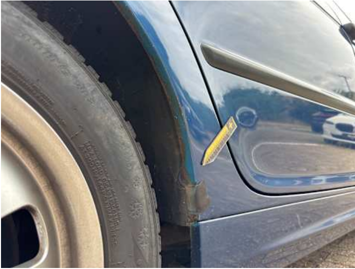
Seitenteil hinten rechts (Rost)
