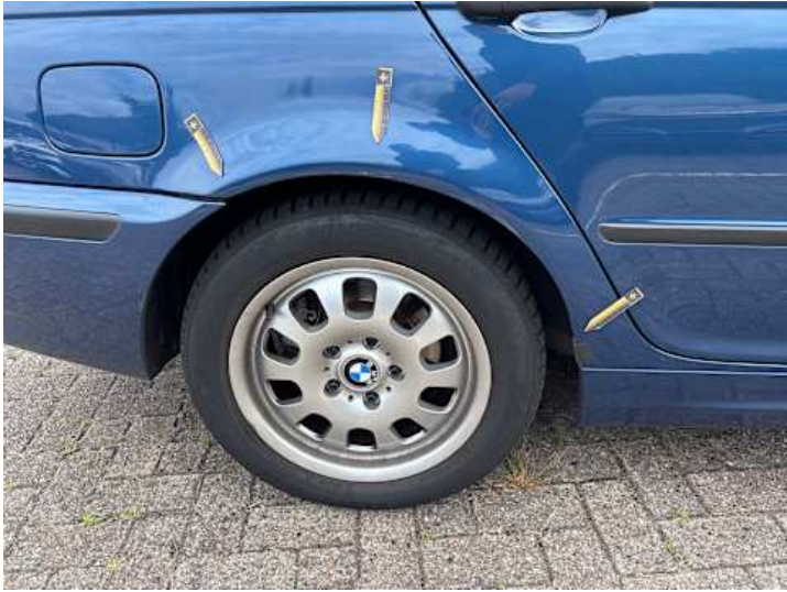
Seitenteil hinten rechts (Rost)
