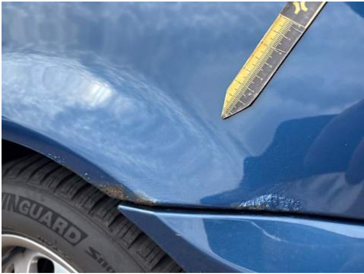
Seitenteil hinten links (Rost)
