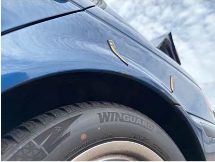
Seitenteil hinten links (Rost)
