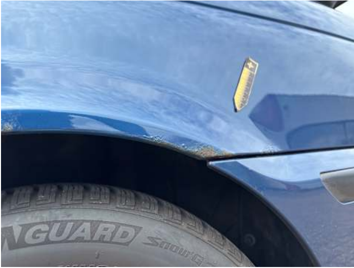
Seitenteil hinten links (Rost)
