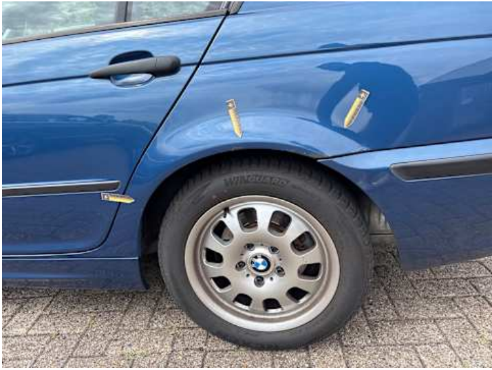
Seitenteil hinten links (Rost)
