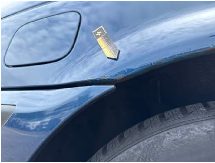
Seitenteil hinten rechts (Rost)
