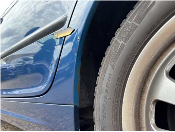
Seitenteil hinten links (Rost)
