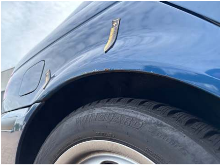
Seitenteil hinten rechts (Rost)
