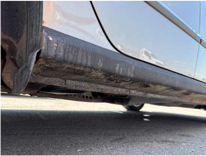
Schweller rechts (Rost)
