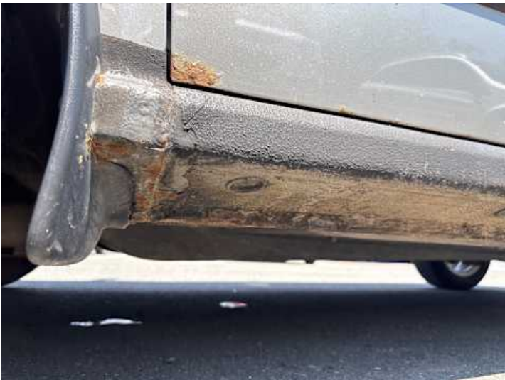
Schweller links (Rost)
