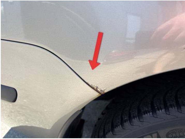
Seitenteil hinten rechts (Kratzer, Lackschaden, Rost)
