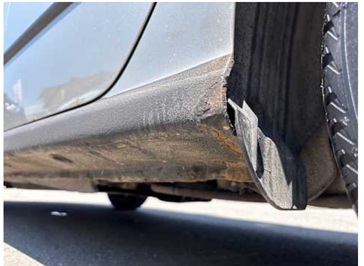
Schweller links (Rost)
