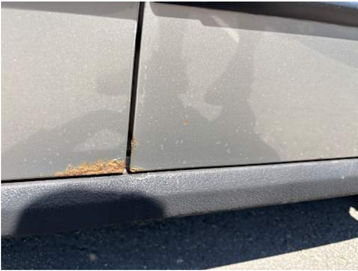
Türe hinten links (Rost)
