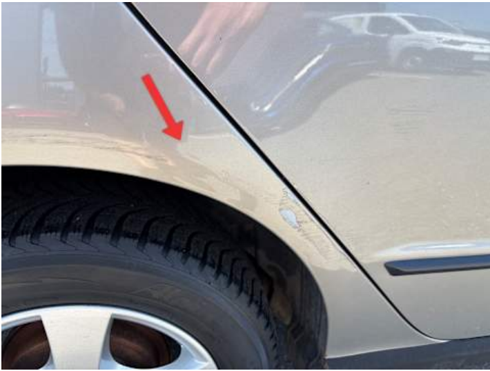
Seitenteil hinten rechts (Kratzer, Lackschaden, Rost)
