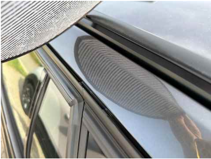
Seitenteil hinten links (Delle)
