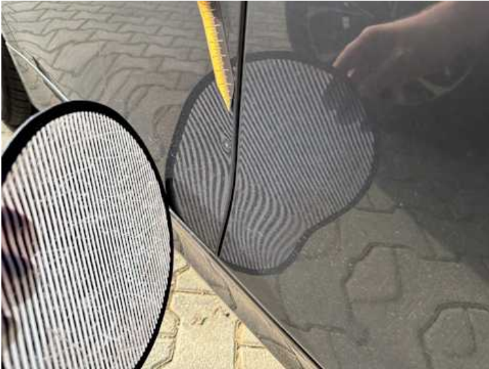
Türe hinten rechts (Kratzer, Delle)
