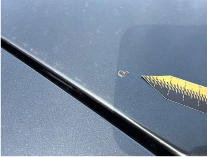
Dach (Kratzer, Lackschaden)
