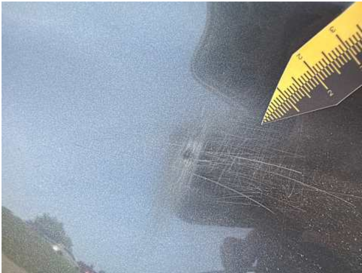
Kotflügel vorne links (Kratzer)
