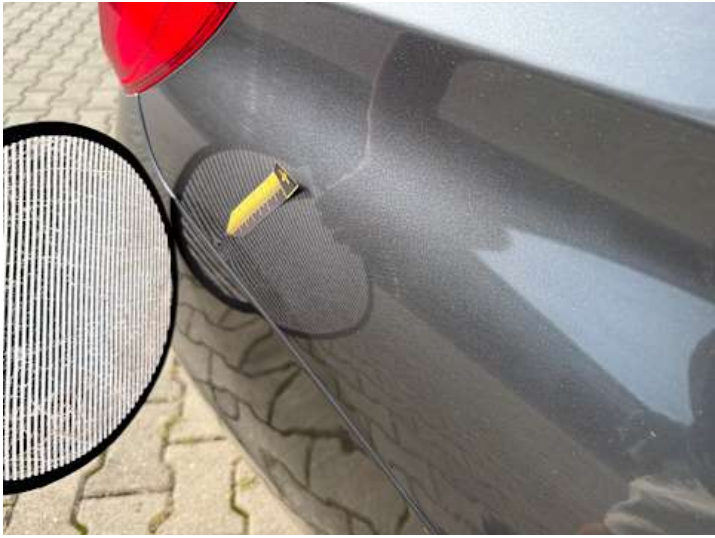
Seitenteil hinten rechts (Kratzer, Delle)
