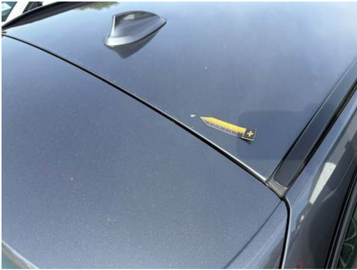
Dach (Kratzer, Lackschaden)
