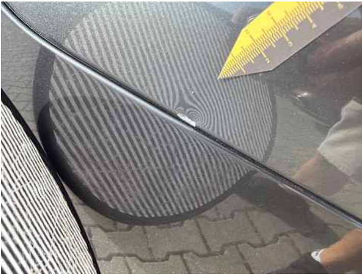
Seitenteil hinten rechts (Kratzer, Delle)
