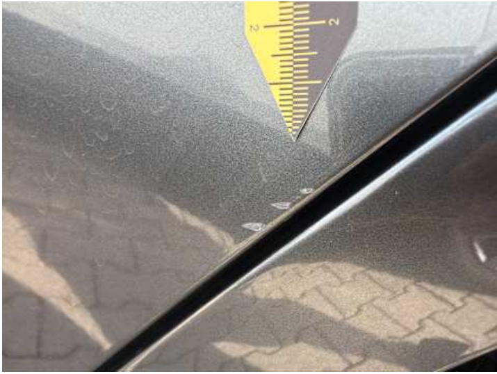
Seitenteil hinten links (Kratzer)
