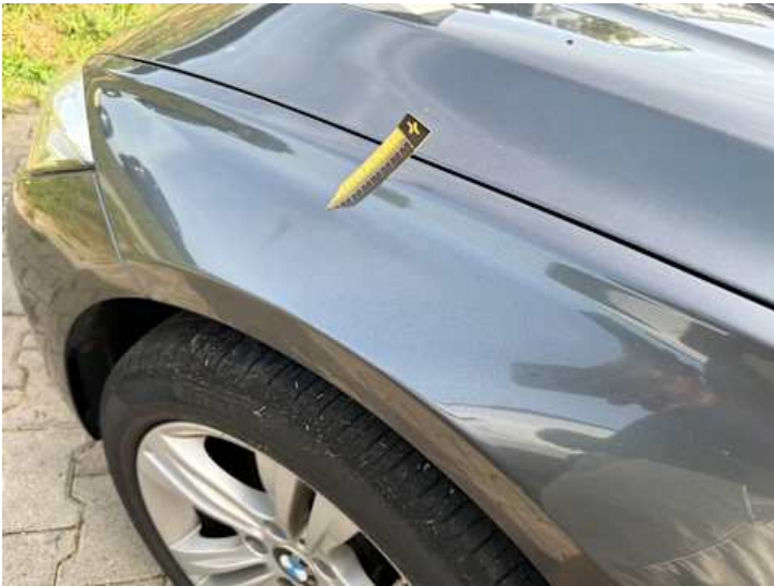
Kotflügel vorne links (Kratzer)
