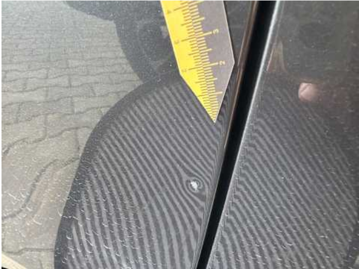
Türe hinten rechts (Kratzer, Delle)
