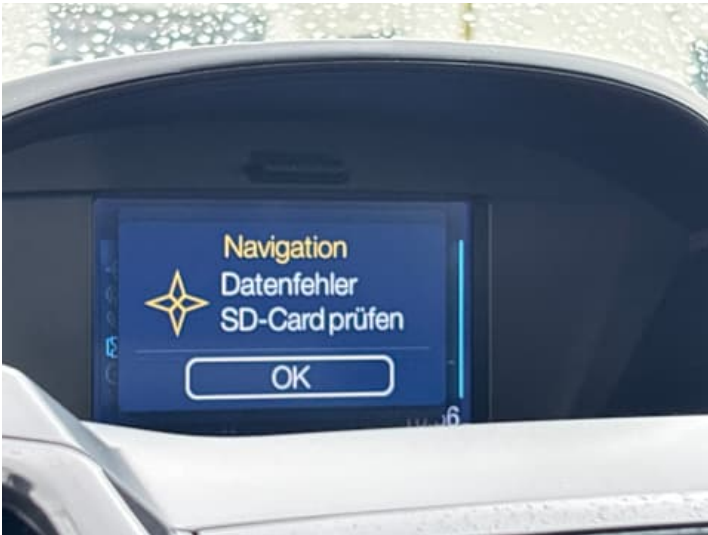
Innenraum (Anderer Schaden): Navi ohne Funktion, SD Fehler
