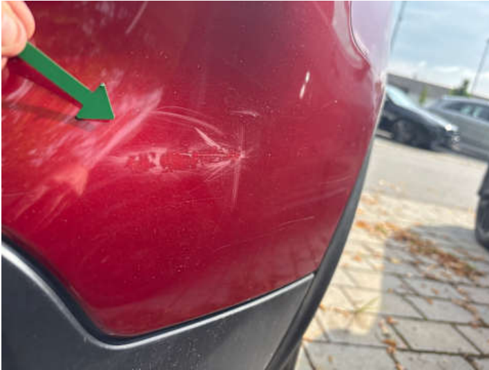
Stoßstange hinten (Kratzer, Lackschaden, Unsachgemäß instand gesetzt)
