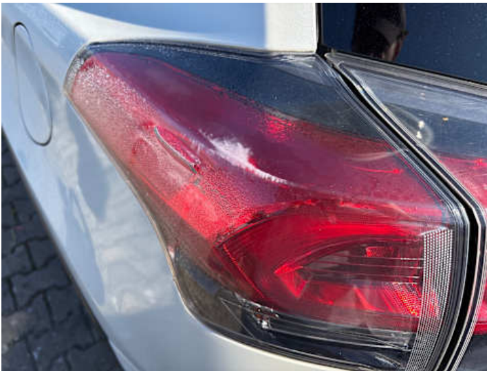
Rücklicht (links) (Undicht)
