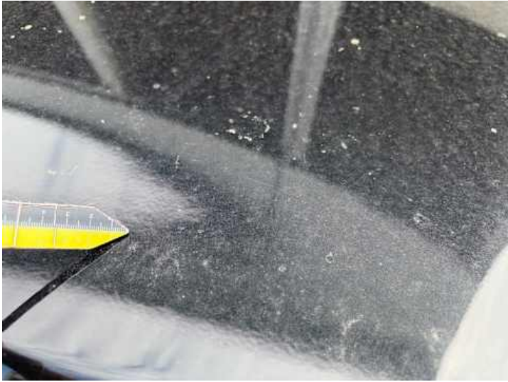
Heckklappe (Lackschaden, Kratzer)
