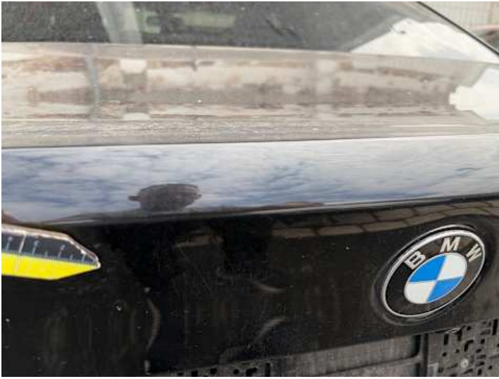
Heckklappe (Lackschaden, Kratzer)
