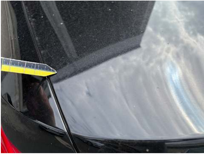
Heckklappe (Lackschaden, Kratzer)
