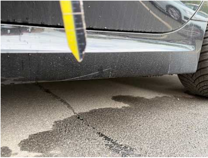
Schweller links (Lackschaden, Kratzer)
