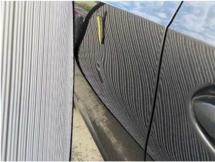
Türe hinten rechts (Delle, Verformung)
