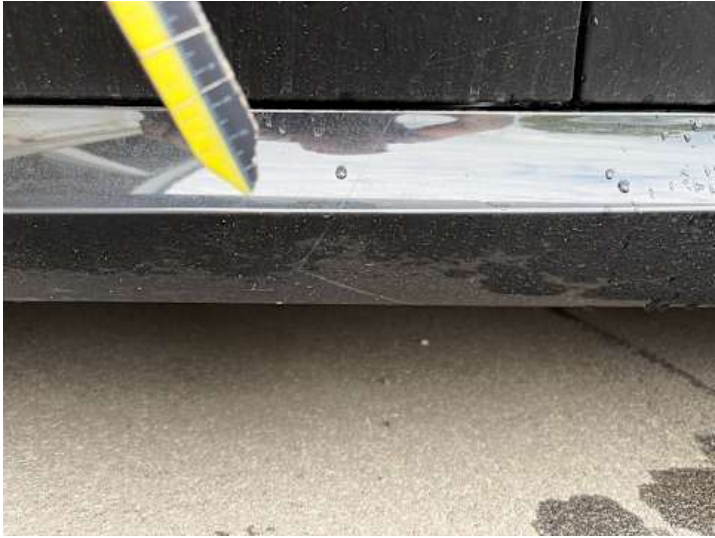
Schweller links (Lackschaden, Kratzer)
