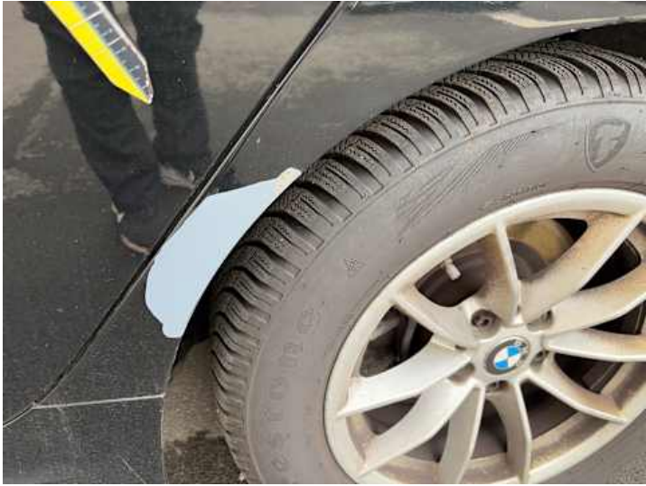
Seitenteil hinten links (Lackschaden, Kratzer, Unsachgemäß instand gesetzt)
