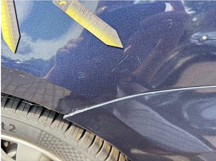
Seitenteil hinten links (Kratzer)
