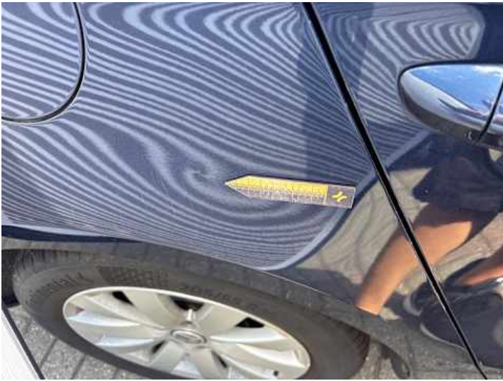
Seitenteil hinten rechts (Kratzer, Delle)
