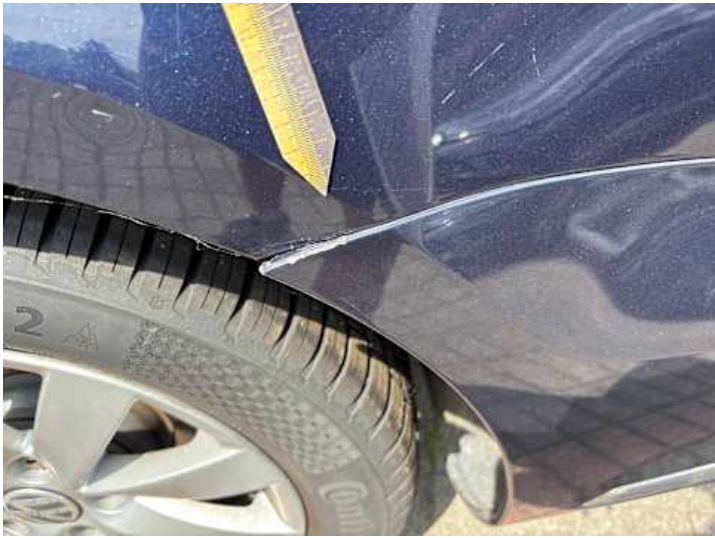
Stoßstange hinten (Spaltmaße ungenau, Kratzer)
