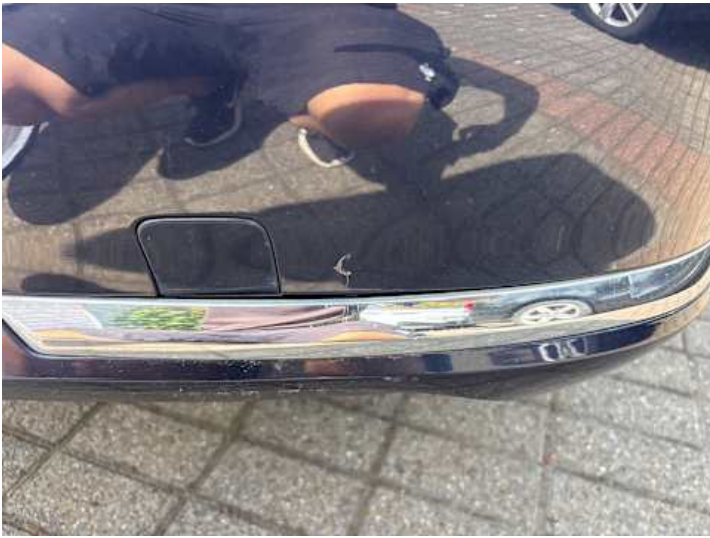
Stoßstange hinten (Kratzer, Riss/Bruch, Verformung)
