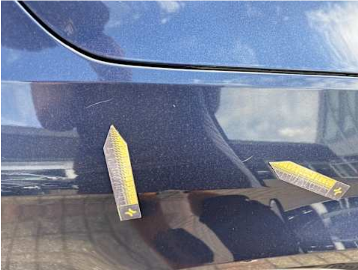
Kotflügel vorne rechts (Kratzer)
