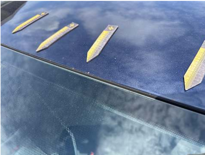
Dach (Steinschlag, Rost)
