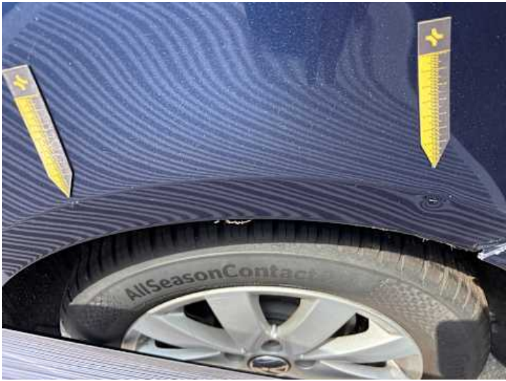
Seitenteil hinten links (Kratzer, Delle)
