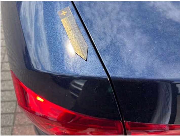
Seitenteil hinten links (Kratzer)
