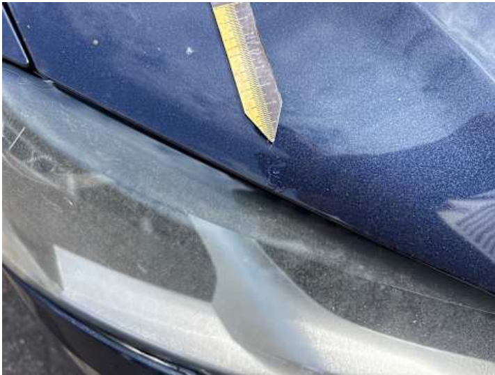
Motorhaube (Unsachgemäß instand gesetzt)
