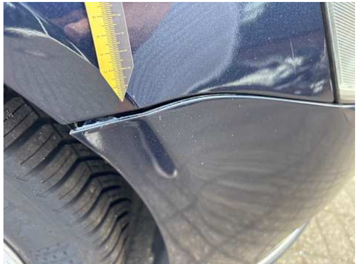
Stoßstange vorne (Spaltmaße ungenau)
