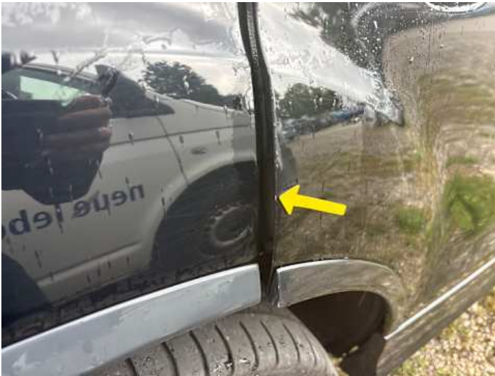
Türe hinten rechts (Lackschaden, Rost)
