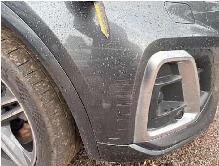
Stoßstange vorne (Lackschaden, Verformung)
