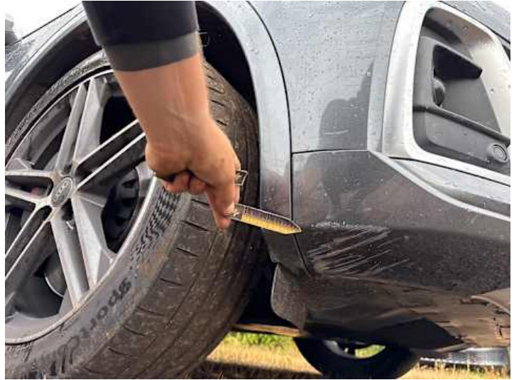
Stoßstange vorne (Lackschaden, Verformung)
