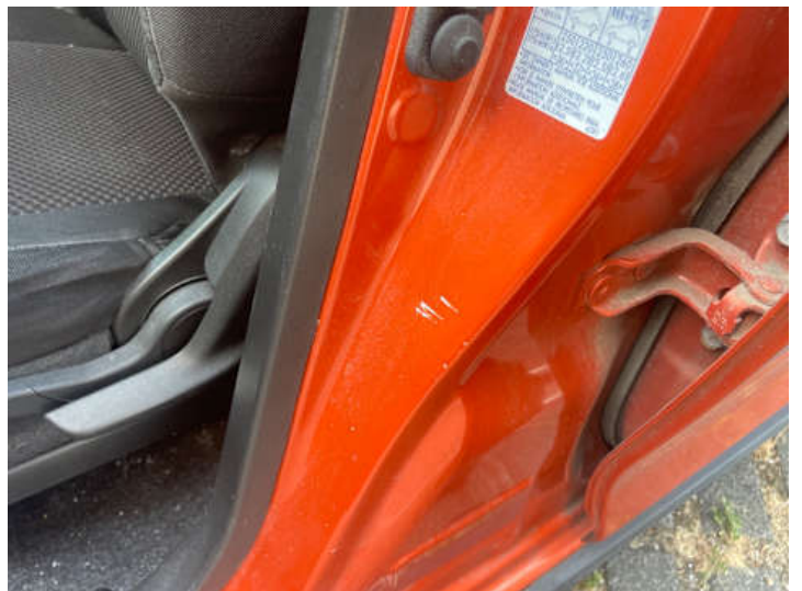
Schweller links (Kratzer)
