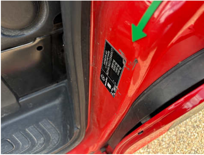
Schweller links (Kratzer, Delle)
