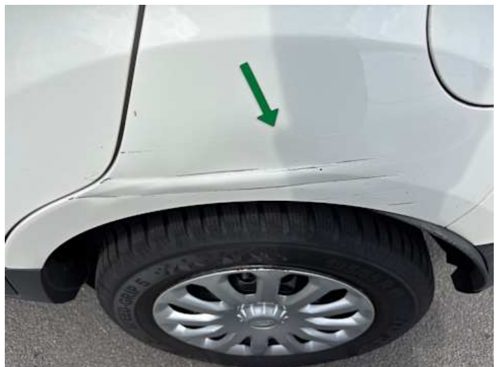
Seitenteil hinten links (Kratzer, Verformung)
