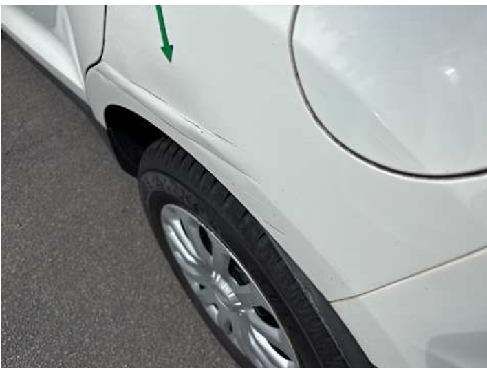
Seitenteil hinten links (Kratzer, Verformung)
