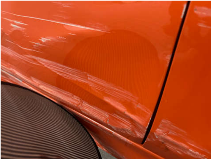
Türe hinten rechts (Kratzer, Verformung)
