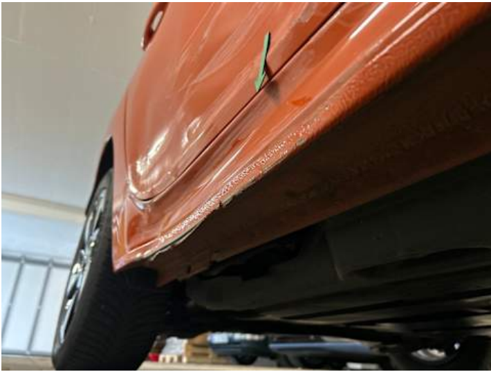
Schweller rechts (Kratzer, Verformung)
