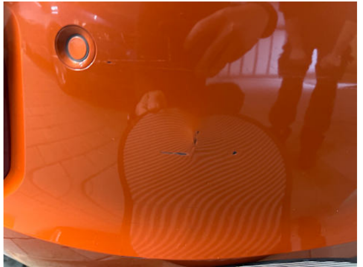
Stoßstange hinten (Verformung)
