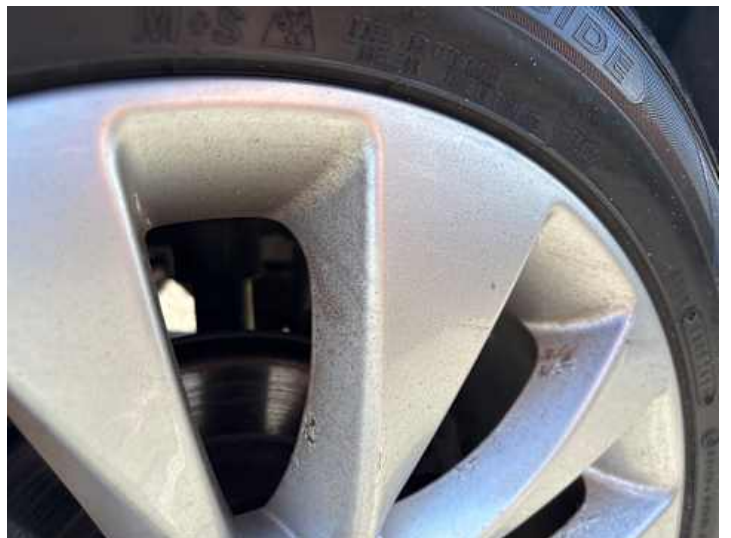
Rad (Anderer Schaden): Lackschaden
