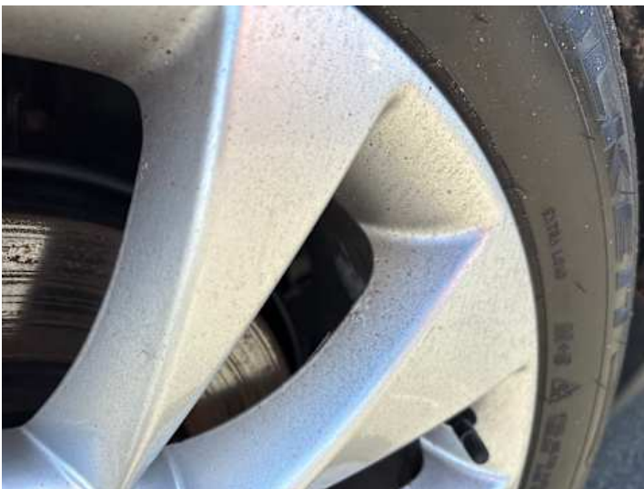
Rad (Anderer Schaden): Lackschaden
