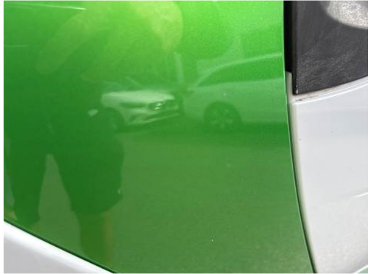
Seitenteil hinten rechts (Lackschaden)
