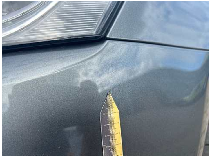
Stoßstange vorne (Unsachgemäß instand gesetzt)
