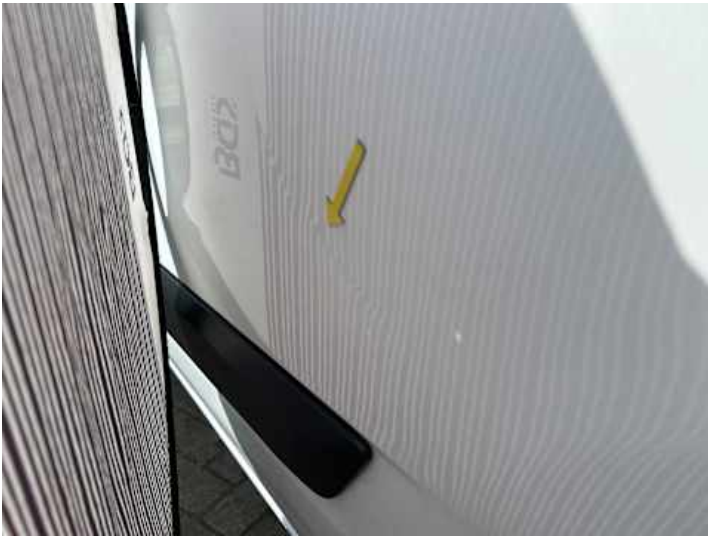
Seitenteil hinten links (Verformung)
