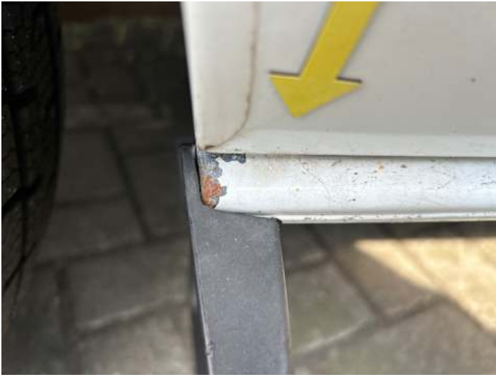
Schweller links (Lackschaden)
