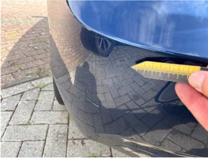
Stoßstange hinten (Kratzer)
