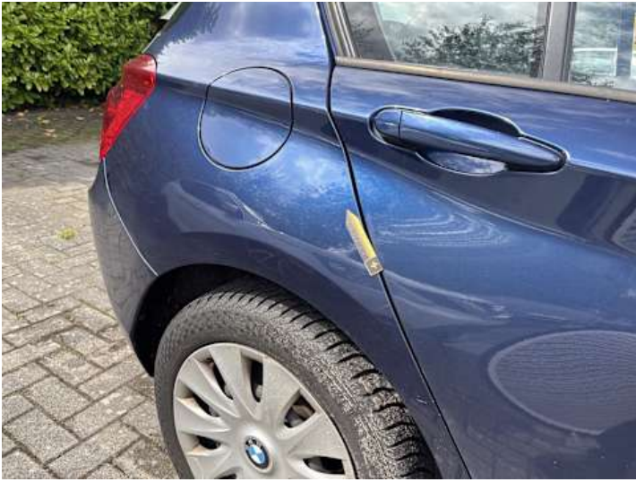
Seitenteil hinten rechts (Kratzer)
