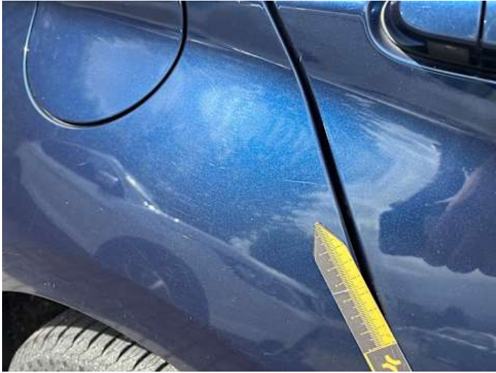
Seitenteil hinten rechts (Kratzer)
