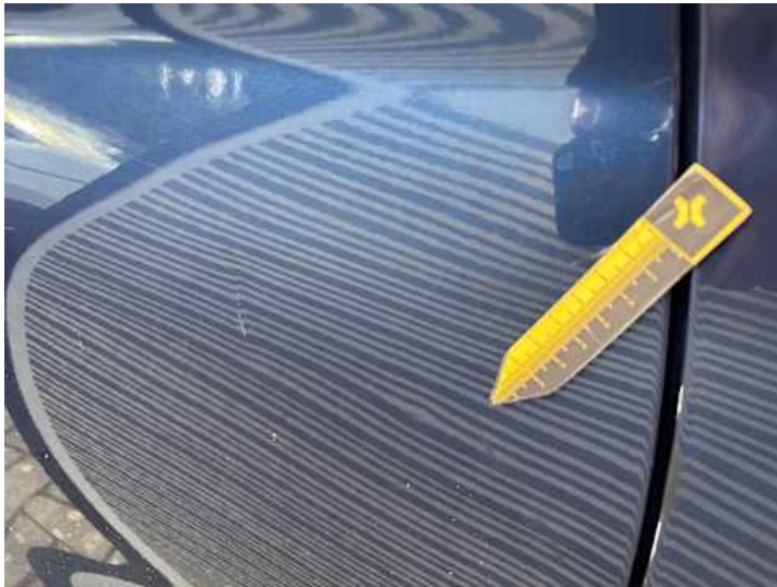
Türe hinten rechts (Delle)
