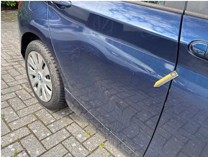
Türe hinten rechts (Delle)
