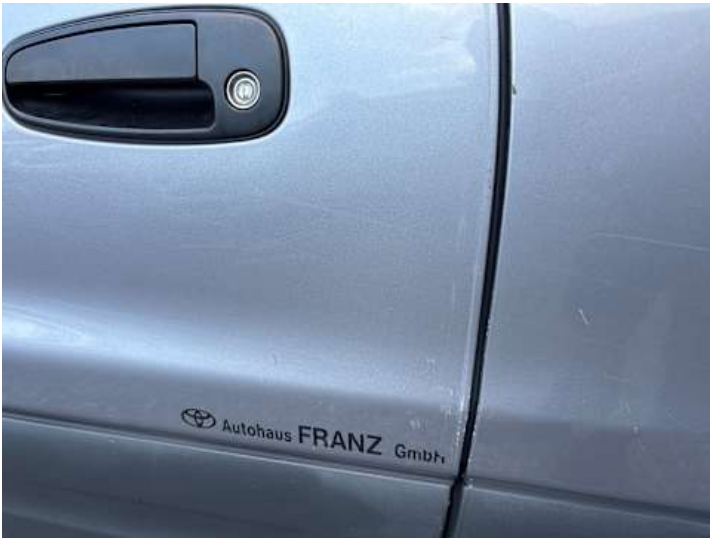
Fahrtür (Kratzer, Lackschaden)
