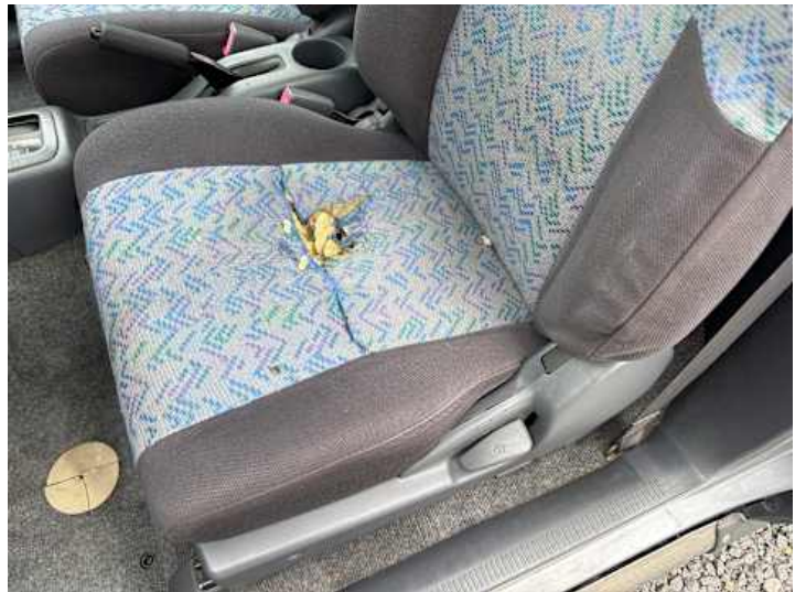
Innenraum (Verschleiß, Riss/Bruch, Brandloch)
