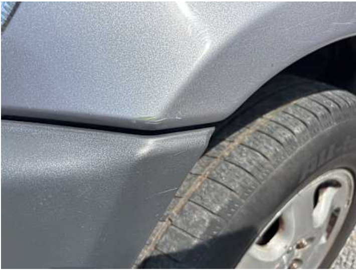
Kotflügel vorne links (Kratzer)
