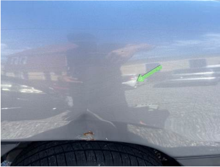
Seitenteil hinten rechts (Lackschaden, Delle, Rost)
