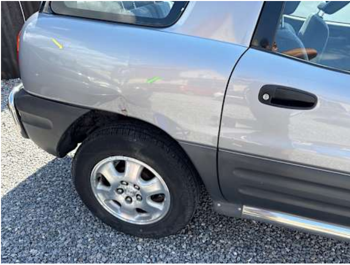
Seitenteil hinten rechts (Lackschaden, Delle, Rost)
