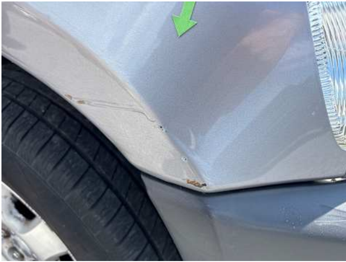
Kotflügel vorne rechts (Kratzer, Lackschaden, Delle, Rost)
