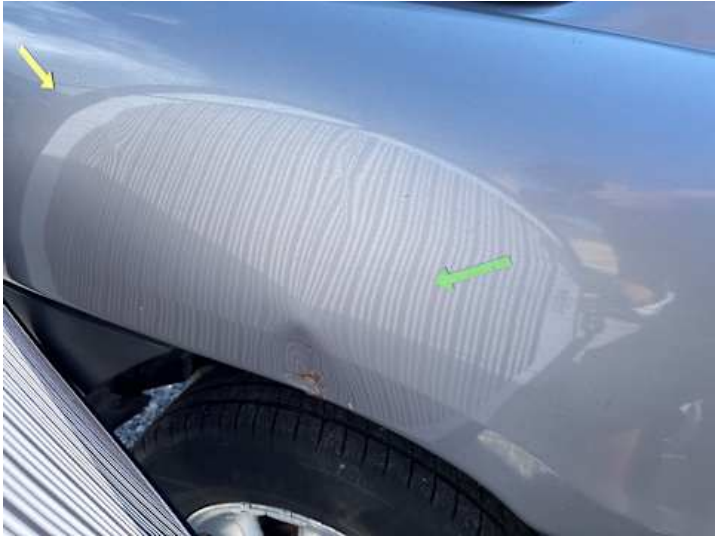
Seitenteil hinten rechts (Lackschaden, Delle, Rost)
