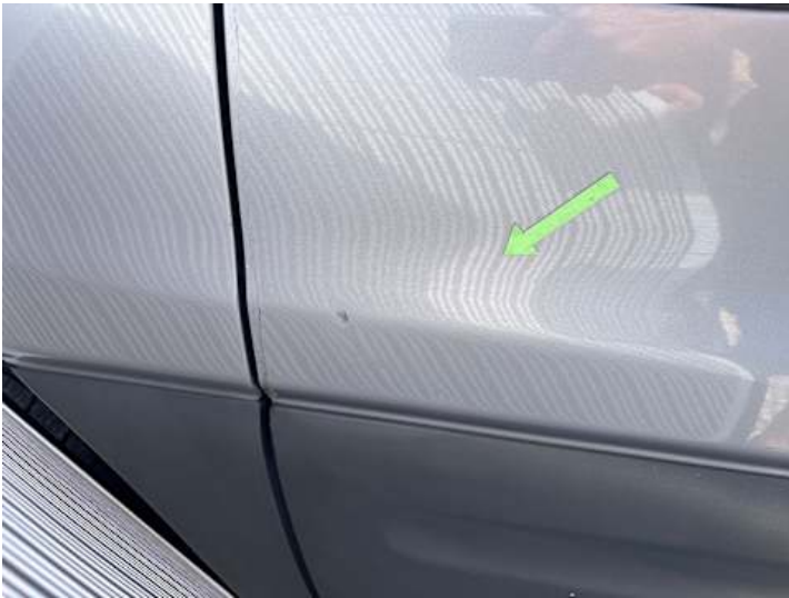
Beifahrtür (Kratzer, Delle)
