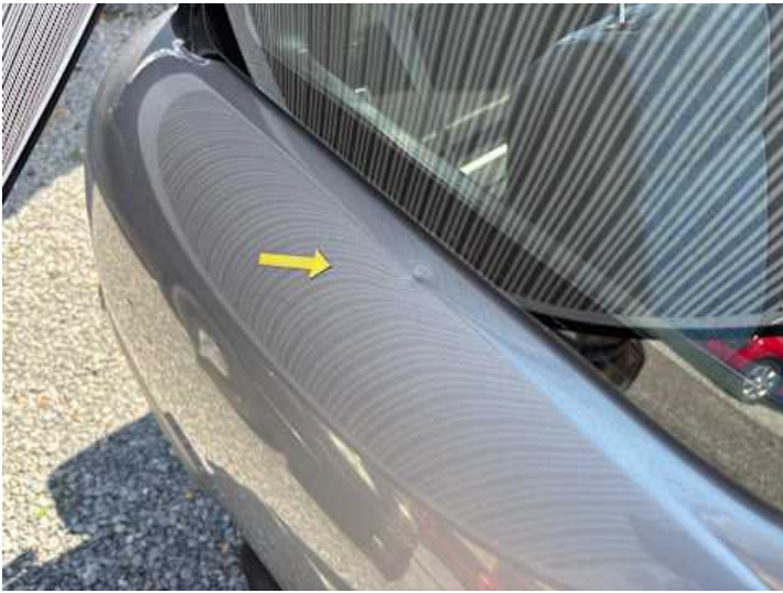
Seitenteil hinten rechts (Delle)
