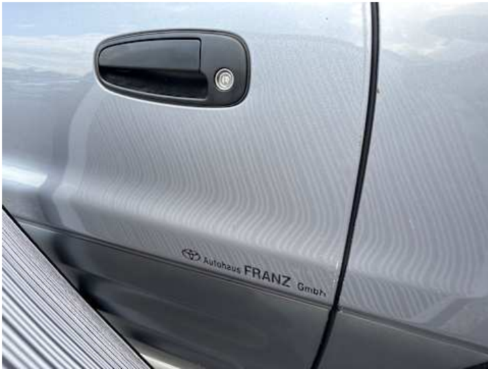
Fahrtür (Kratzer, Lackschaden)
