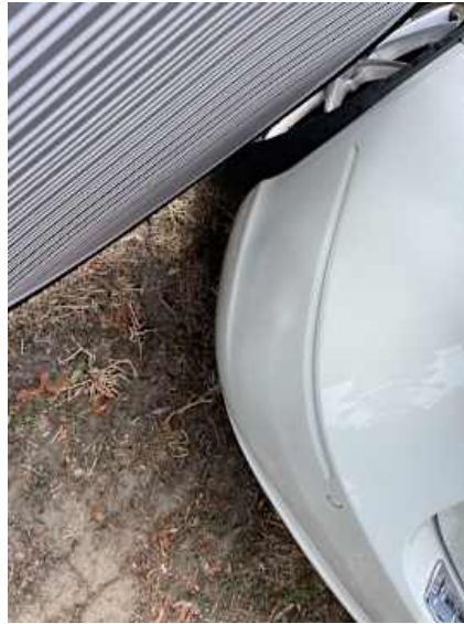
Stoßstange hinten (Verformung, Spaltmaße ungenau)
