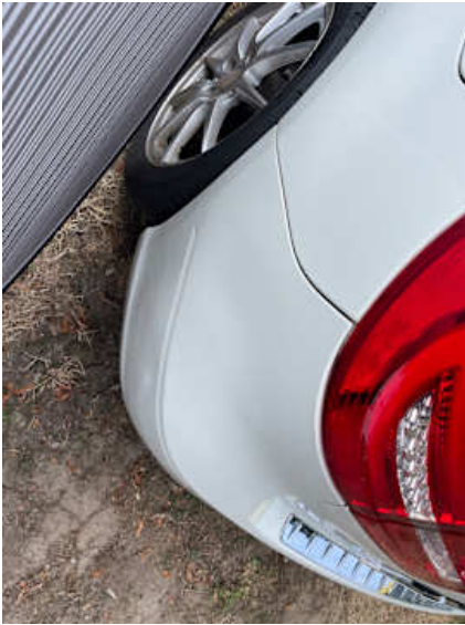
Stoßstange hinten (Verformung, Spaltmaße ungenau)
