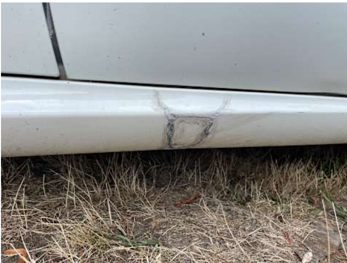
Schweller links (Unsachgemäß instand gesetzt)
