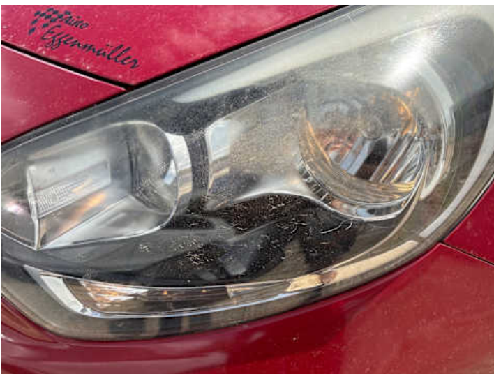
Scheinwerfer (links) (Blind, Riss/Bruch)
