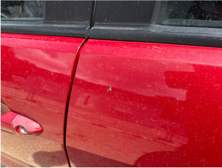
Türe hinten links (Lackschaden, Ausgeblichen/Matt)
