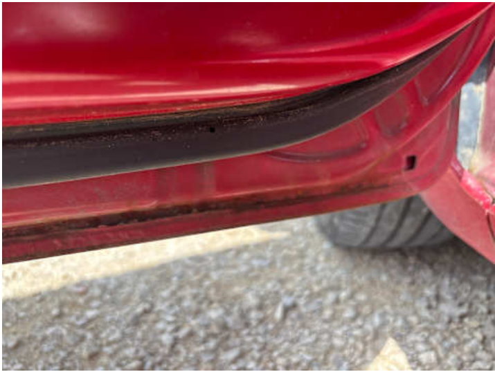
Fahrertür (Lackschaden, Rost)
