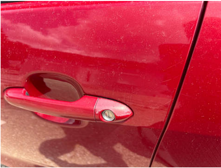
Fahrertür (Lackschaden, Ausgeblichen/Matt, Kratzer, Delle)
