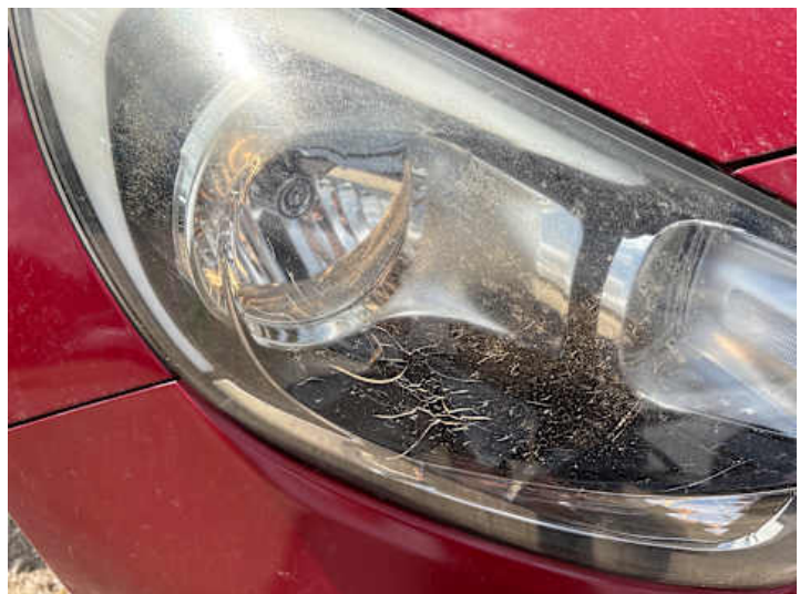
Scheinwerfer (rechts) (Riss/Bruch, Blind)
