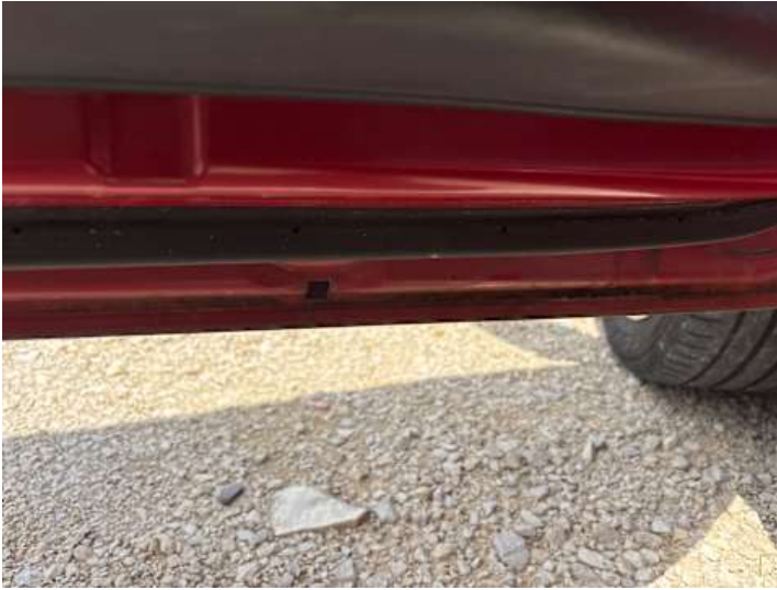
Fahrertür (Lackschaden, Rost)
