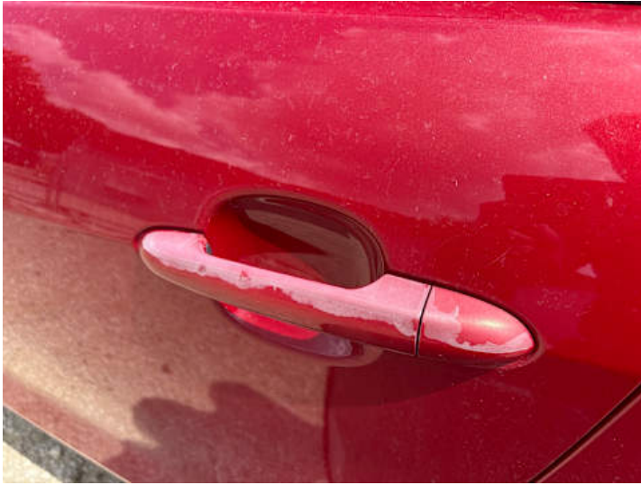
Türe hinten links (Lackschaden, Ausgeblichen/Matt)
