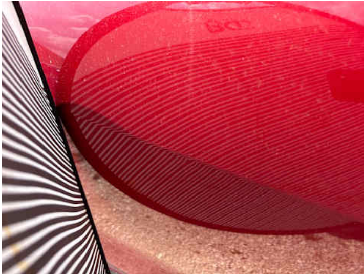
Türe hinten rechts (Lackschaden, Delle, Ausgeblichen/Matt)
