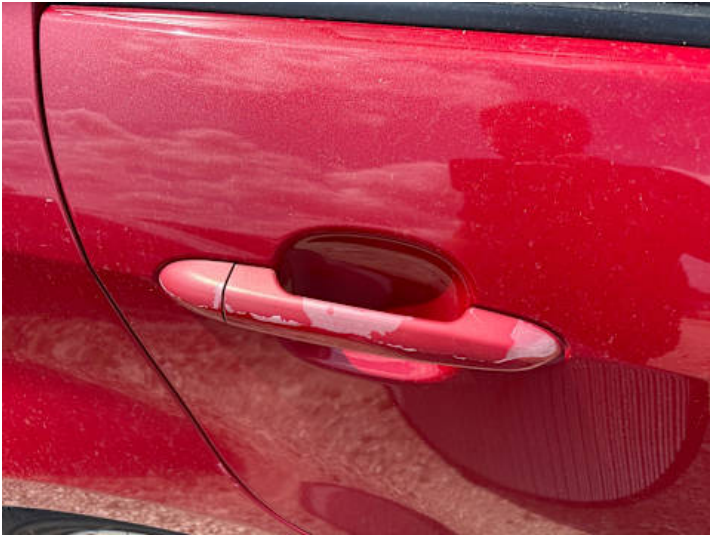
Türe hinten rechts (Lackschaden, Delle, Ausgeblichen/Matt)
