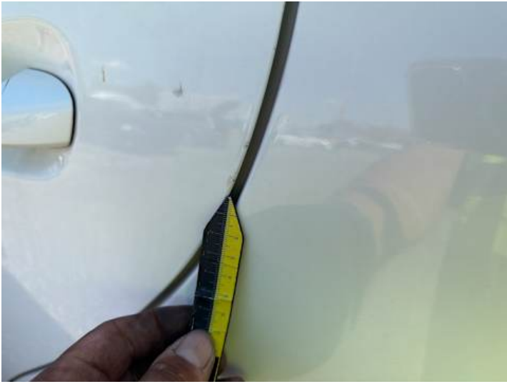
Türe hinten links (Lackschaden)
