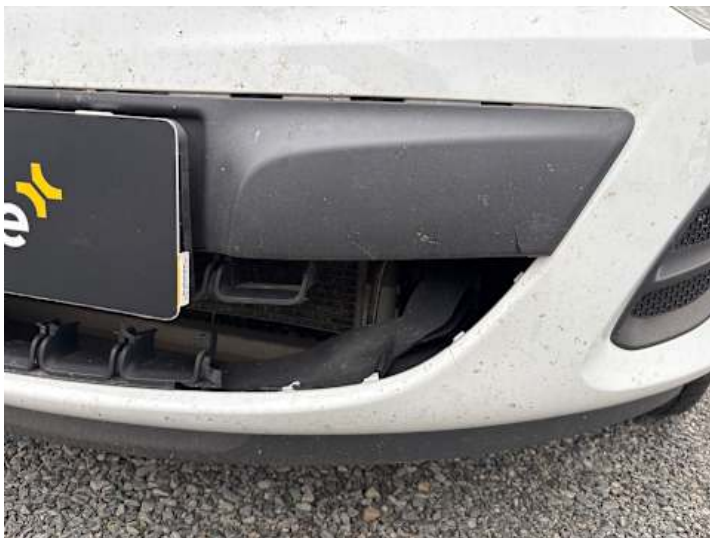
Stoßstange vorne (Riss/Bruch, Verformung)
