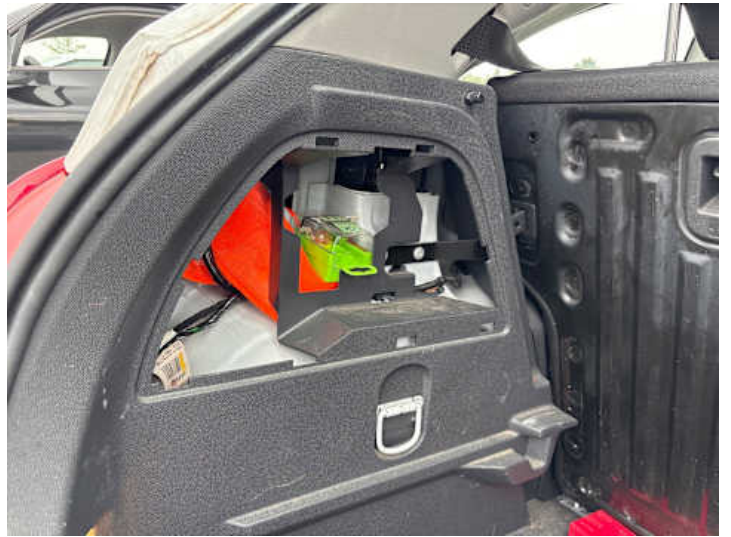
Innenraum (Anderer Schaden): Abdeckung fehlt
