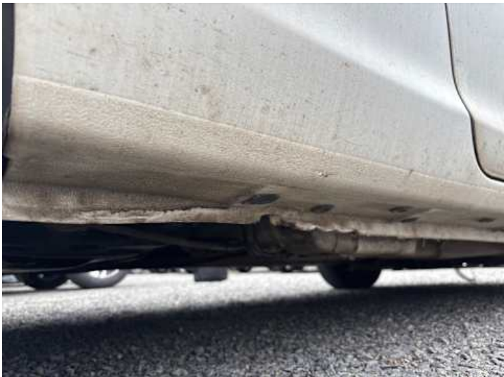
Schweller rechts (Verformung)
