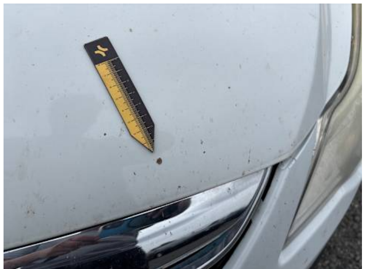
Motorhaube (Lackschaden, Rost)
