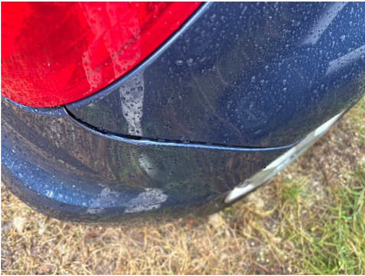
Stoßstange hinten (Spaltmaße ungenau)
