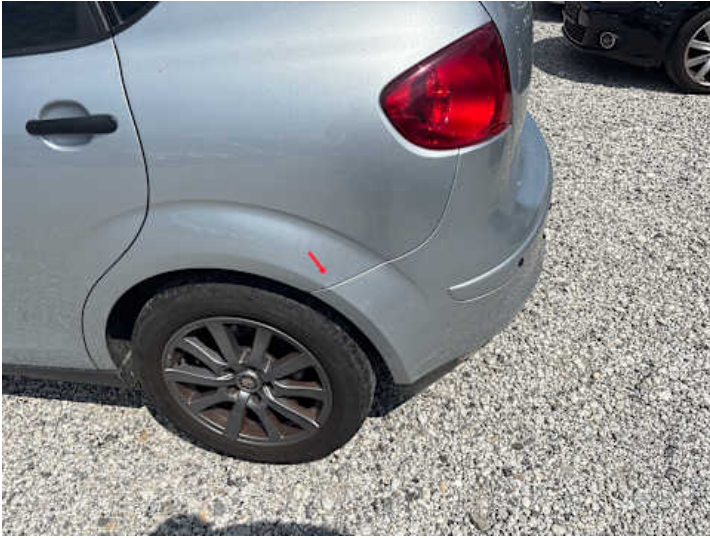
Seitenteil hinten links (Rost, Lackschaden)
