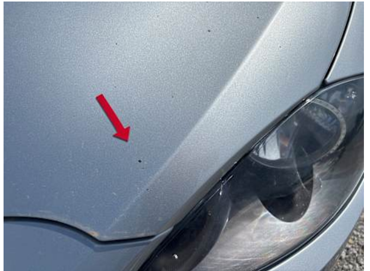
Motorhaube (Lackschaden, Steinschlag)
