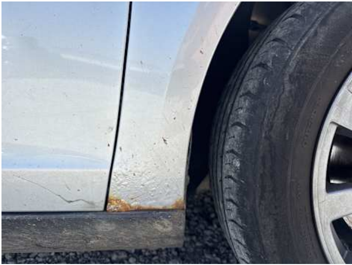
Kotflügel vorne rechts (Lackschaden, Rost)
