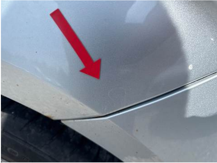
Seitenteil hinten links (Rost, Lackschaden)
