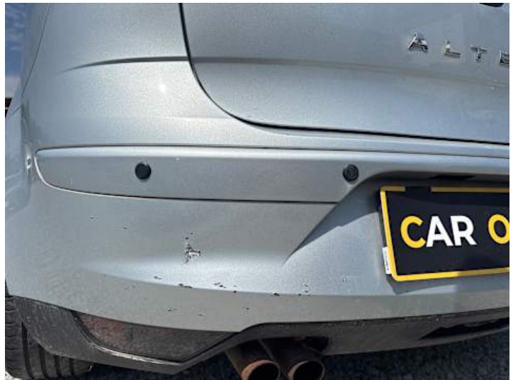
Stoßstange hinten (Lackschaden)
