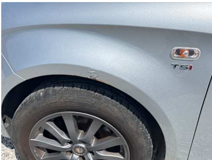
Kotflügel vorne links (Rost)
