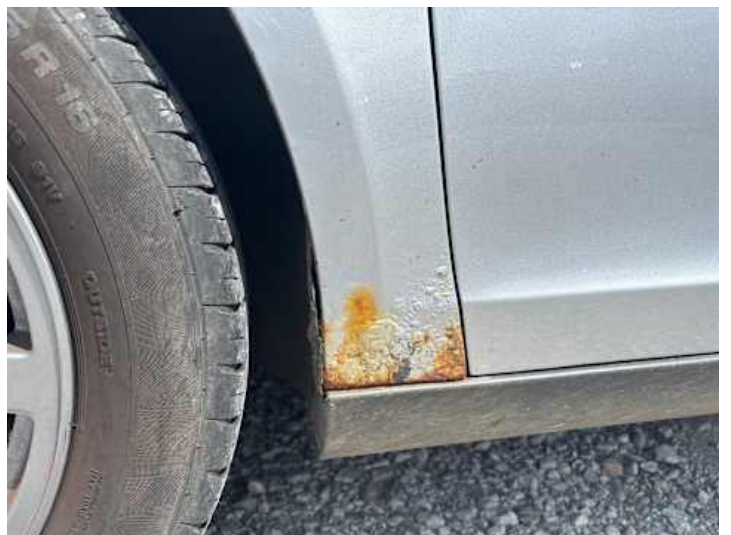
Kotflügel vorne links (Rost)
