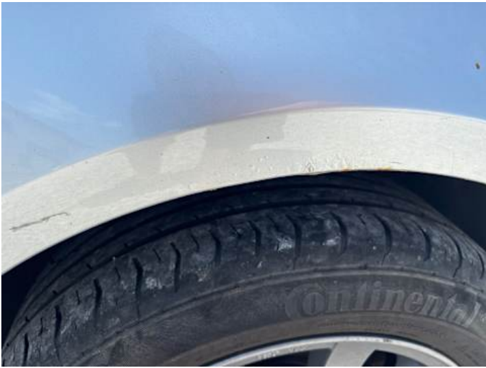
Kotflügel vorne rechts (Lackschaden, Rost)
