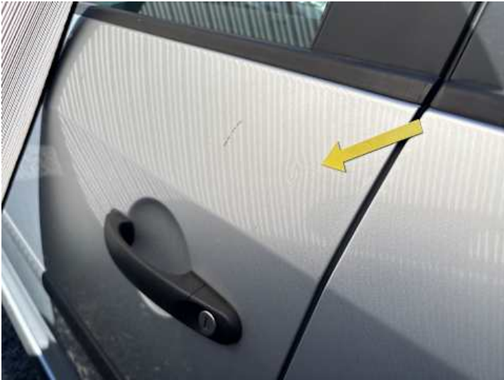
Fahrtür (Delle, Lackschaden)
