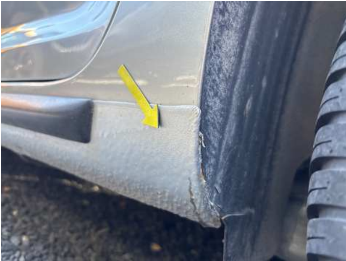
Schweller links (Rost)
