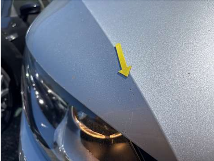
Motorhaube (Steinschlag, Lackschaden)
