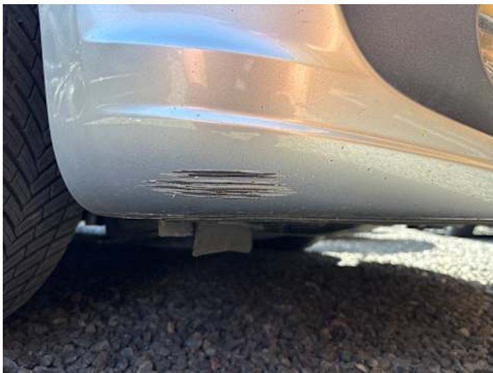
Stoßstange vorne (Kratzer, Lackschaden)
