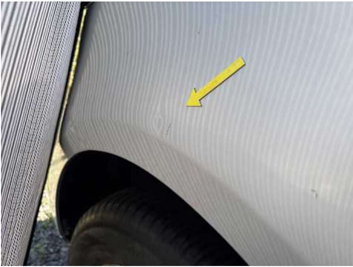
Seitenteil hinten rechts (Delle)
