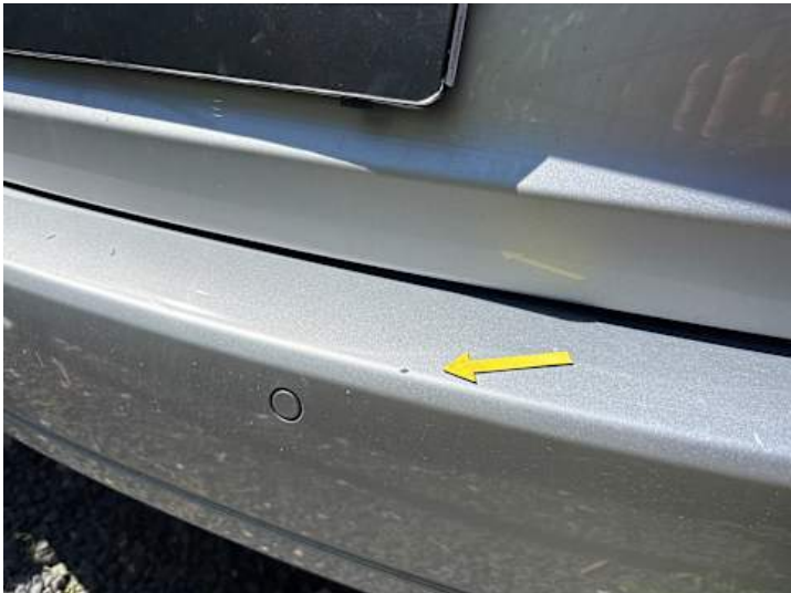
Stoßstange hinten (Lackschaden, Kratzer)
