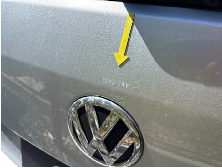
Heckklappe (Kratzer, Lackschaden)
