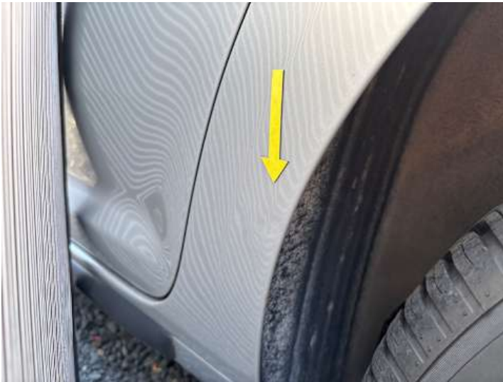
Seitenteil hinten links (Delle)
