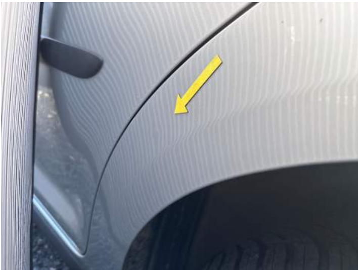
Seitenteil hinten links (Delle)
