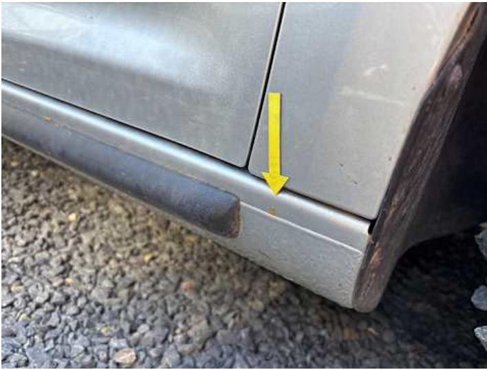
Schweller rechts (Lackschaden, Rost)
