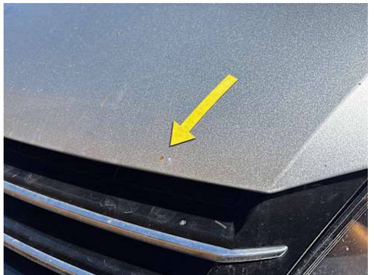
Motorhaube (Lackschaden, Rost)
