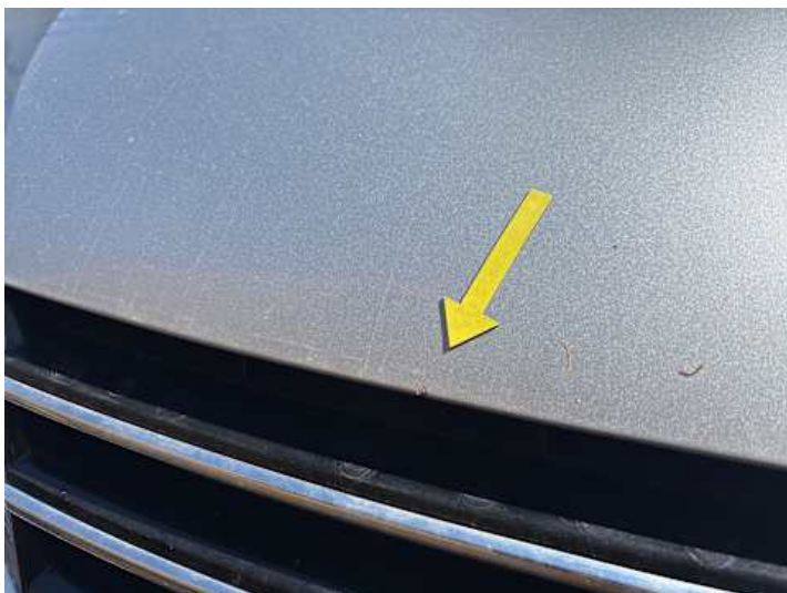
Motorhaube (Lackschaden, Rost)
