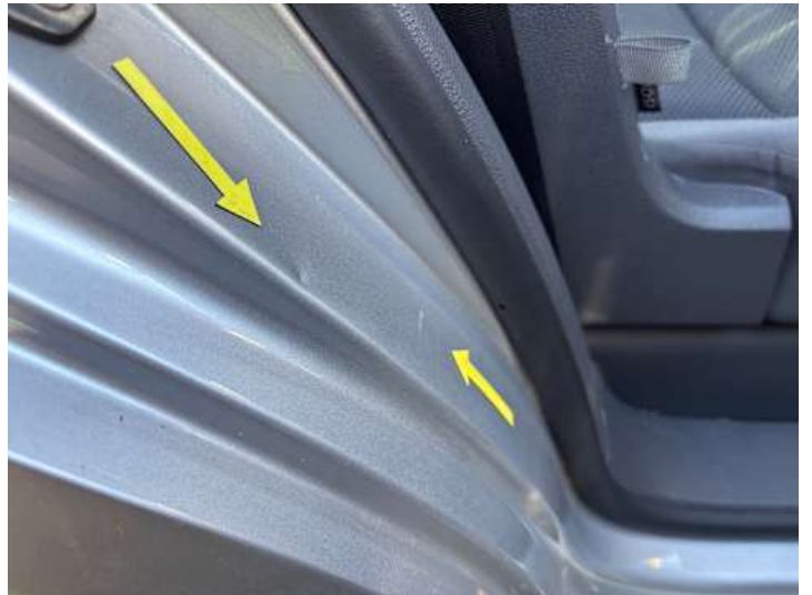
Türe hinten rechts (Lackschaden, Delle)
