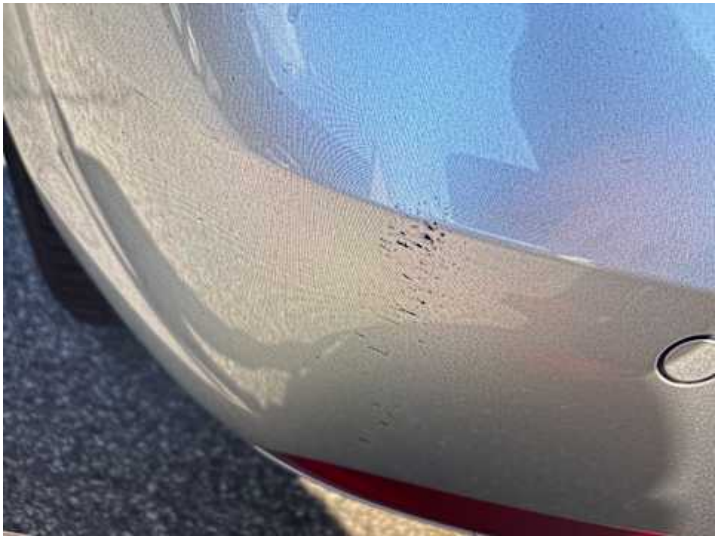
Stoßstange hinten (Kratzer, Lackschaden)
