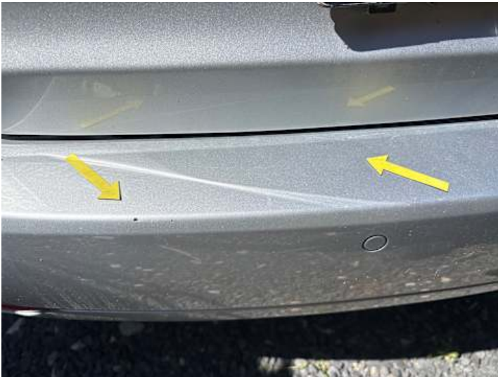
Stoßstange hinten (Lackschaden, Kratzer)
