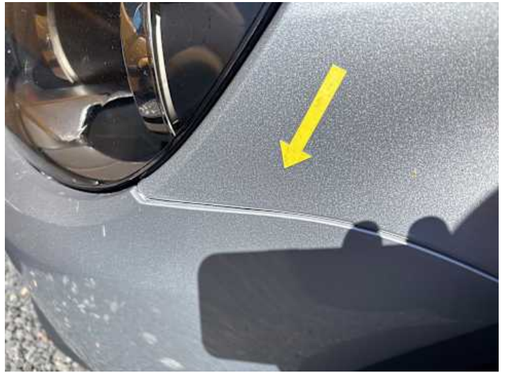
Kotflügel vorne links (Spaltmaße ungenau)
