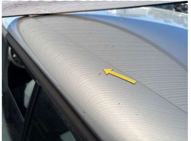
Seitenteil hinten links (Delle)
