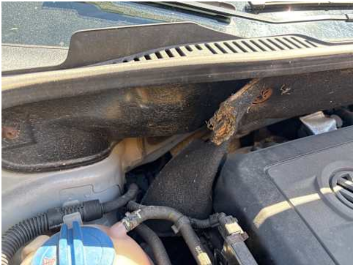
Motorhaube (Anderer Schaden): Dämmmatte beschädigt
