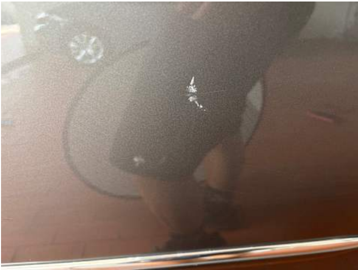
Türe hinten links (Kratzer, Rost)
