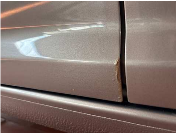
Fahrrertür (Rost, Kratzer)
