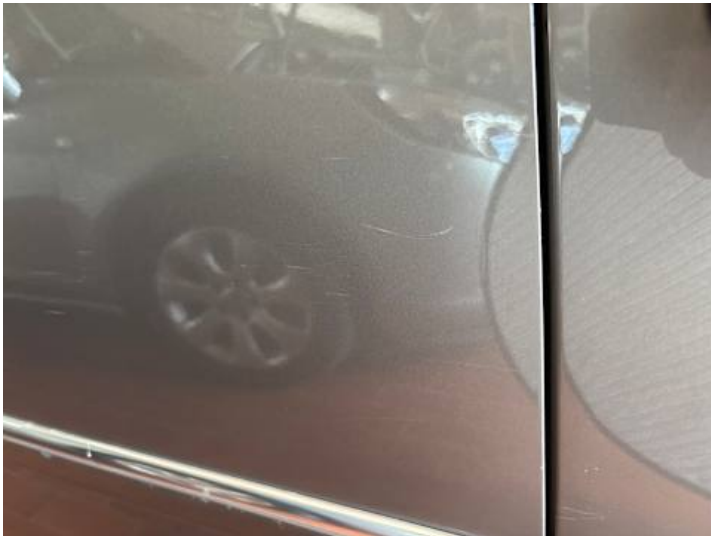
Türe hinten rechts (Kratzer, Delle)
