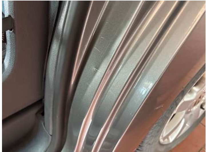
Seitenteil hinten links (Kratzer, Delle)
