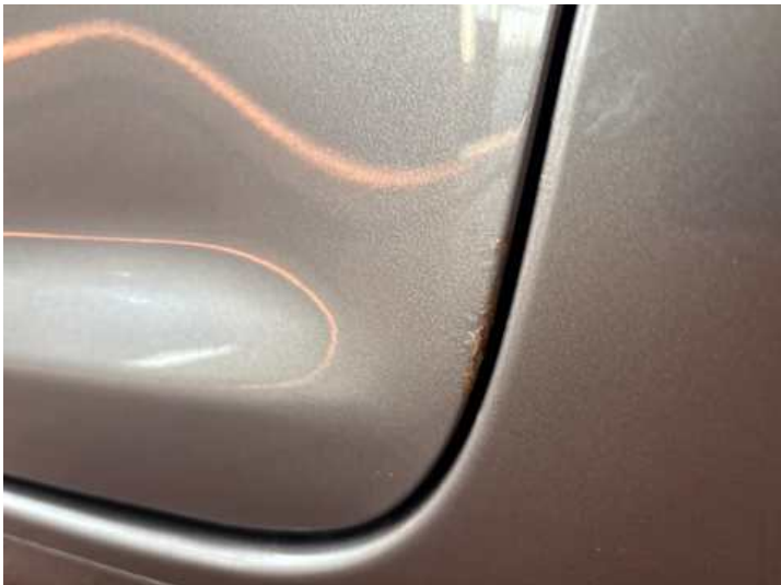
Türe hinten links (Kratzer, Rost)
