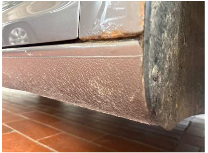
Schweller rechts (Rost)
