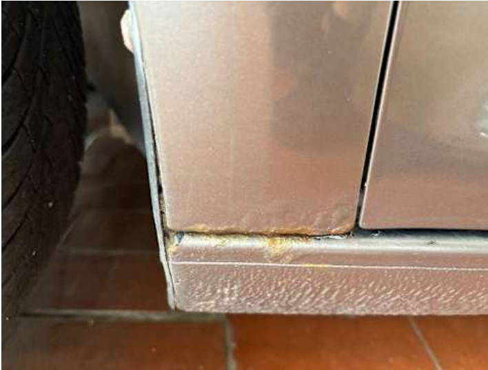
Kotflügel vorne links (Rost)
