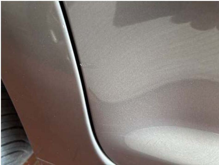
Türe hinten rechts (Kratzer, Delle)
