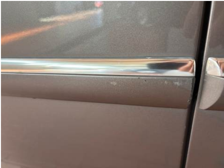
Fahrrertür (Rost, Kratzer)
