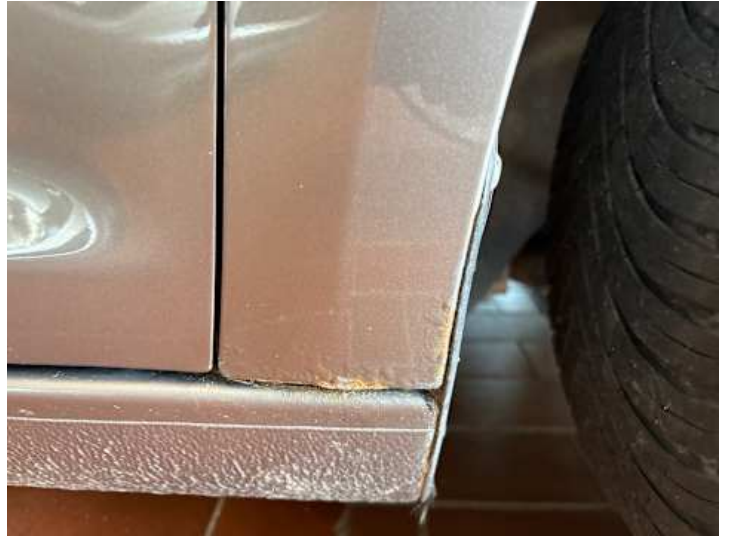
Kotflügel vorne rechts (Kratzer, Rost)
