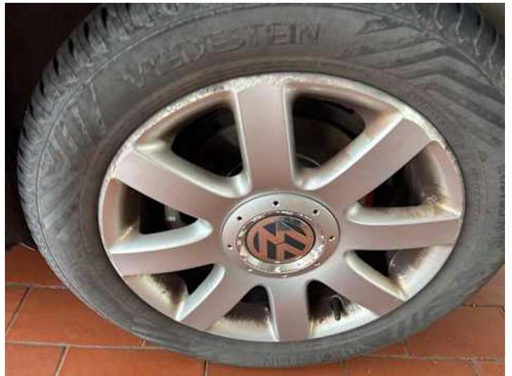
Rad (Kerben, Kratzer, Rost)
