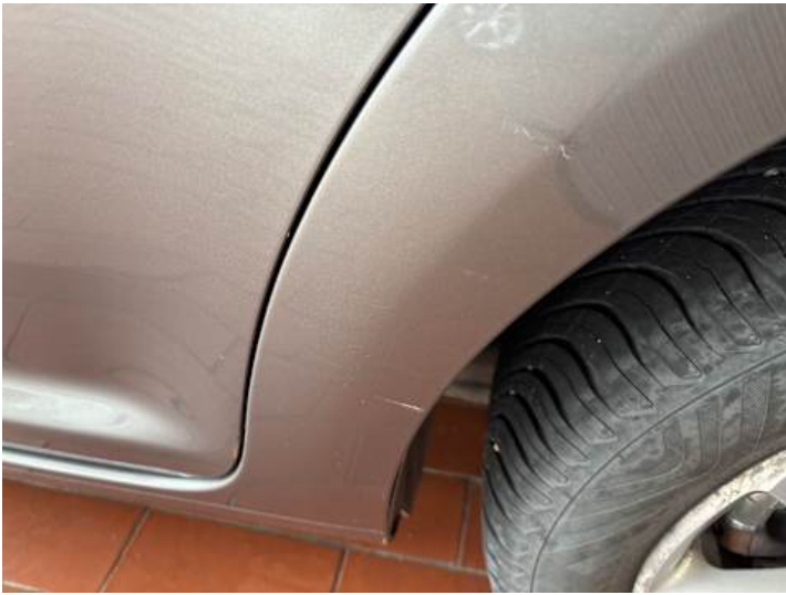
Seitenteil hinten links (Kratzer, Delle)
