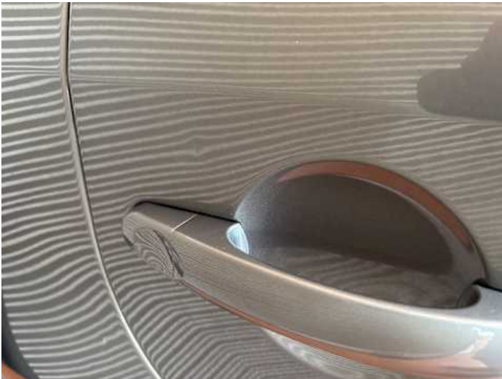
Türe hinten rechts (Kratzer, Delle)
