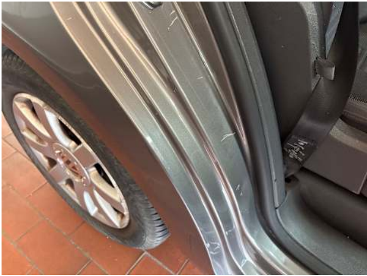
Seitenteil hinten rechts (Kratzer, Delle)
