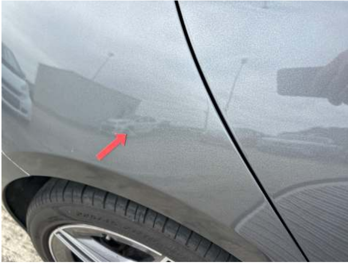
Seitenteil hinten rechts (Verformung)
