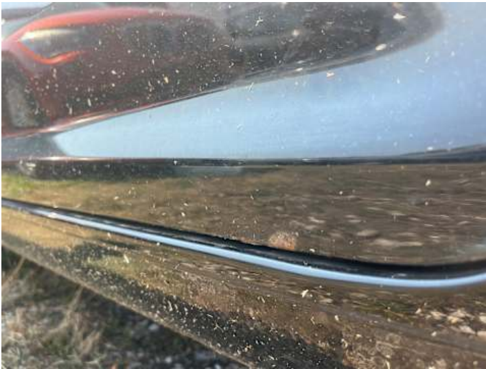
Türe hinten links (Rost)
