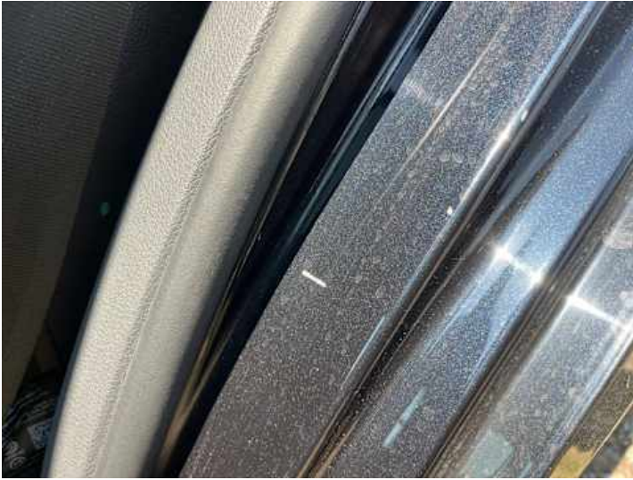
Seitenteil hinten links (Lackschaden, Kratzer, Delle)
