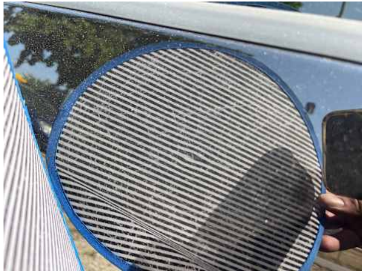
Türe hinten rechts (Delle)
