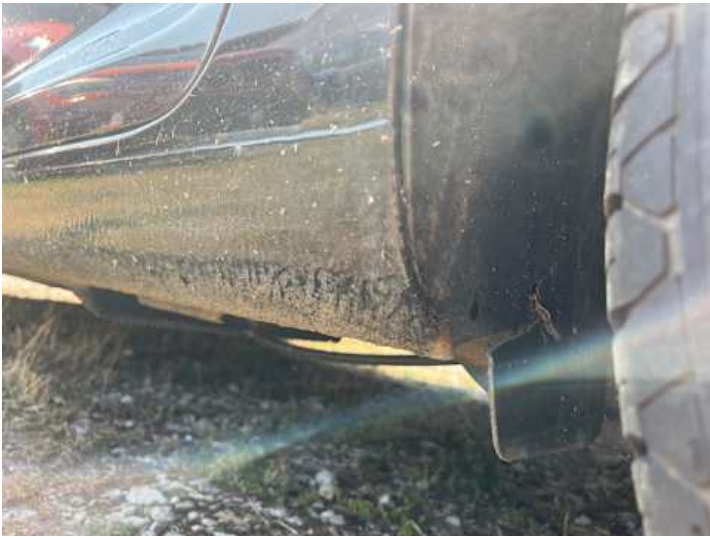
Schweller links (Rost)
