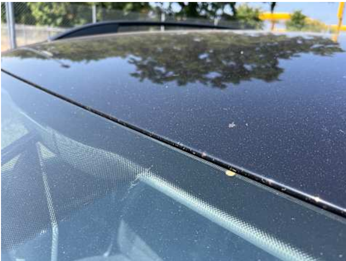
Dach (Lackschaden, Steinschlag)
