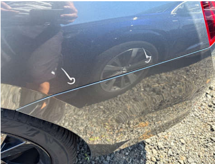
Stoßstange hinten (Lackschaden, Kratzer, Spaltmaße ungenau)
