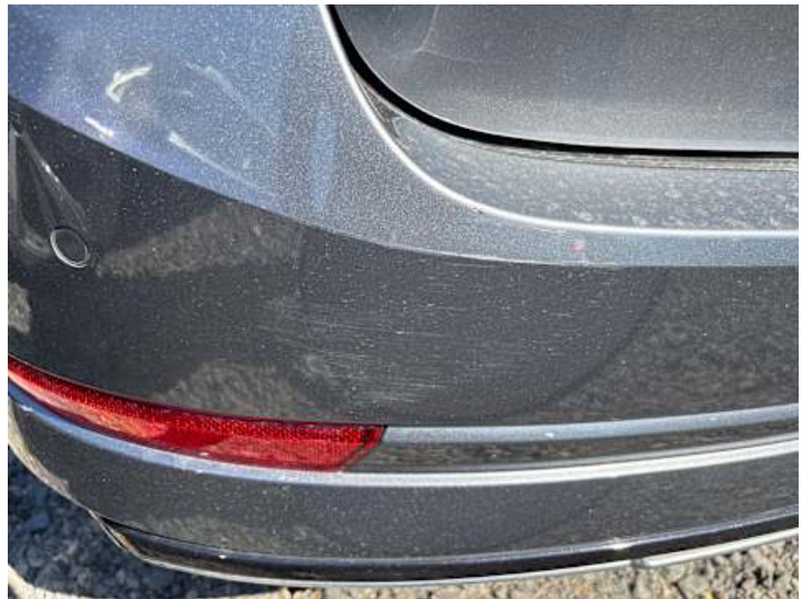
Stoßstange hinten (Lackschaden, Kratzer, Spaltmaße ungenau)
