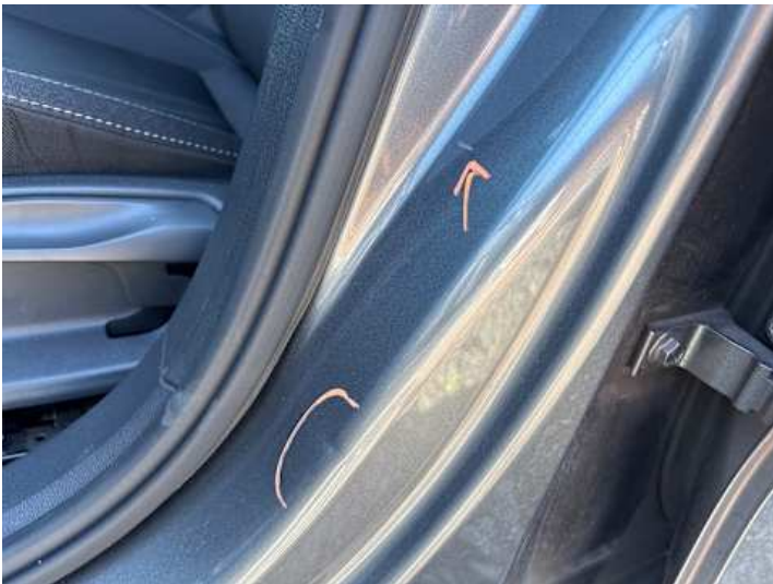
Schweller links (Delle, Lackschaden)
