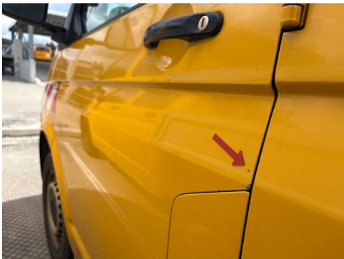
Fahrtür (Kratzer, Rost)
