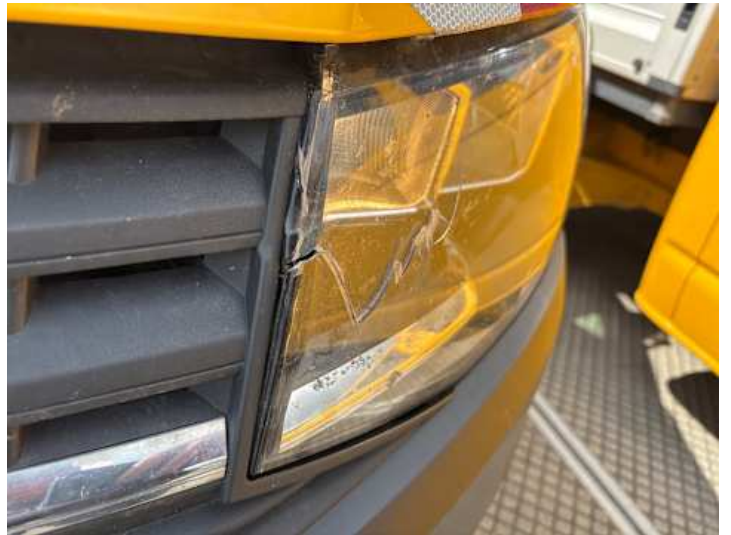
Scheinwerfer (links) (Riss/Bruch)
