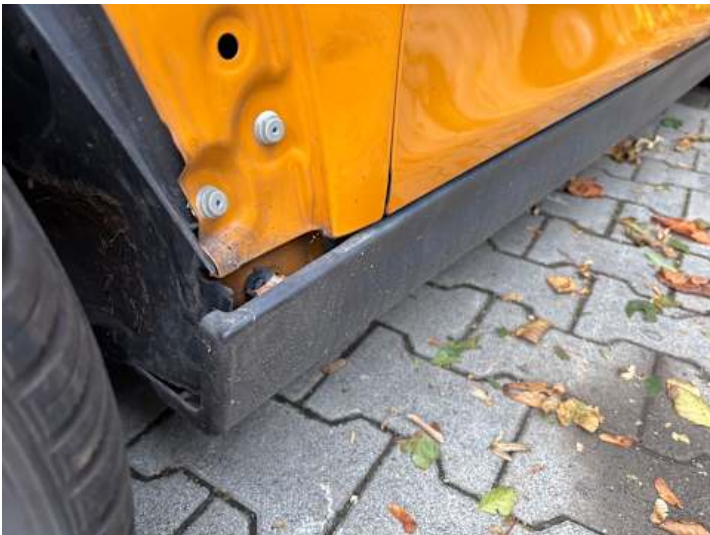
Schweller links (Riss/Bruch)
